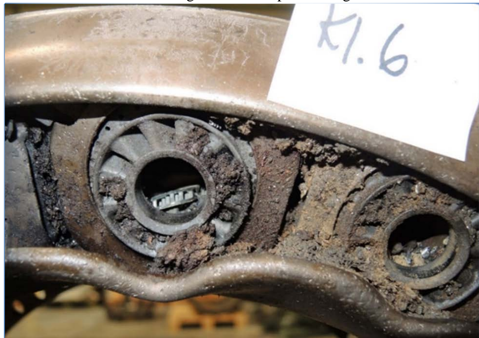
Figur 17. Brännkammarmodul med igensatta turbulatorer. Läge klockan 6, sedd framifrån. Foto: GKN Aerospace Sweden AB.
