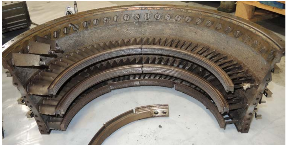
Figur 16. Del av främre högtryckskompressorhuset med ledskenor. De flesta ställbara inloppsledskenorna saknas, se översta raden. De fasta ledskenorna syns på den nedersta raden. Foto: GKN Aerospace Sweden AB.
