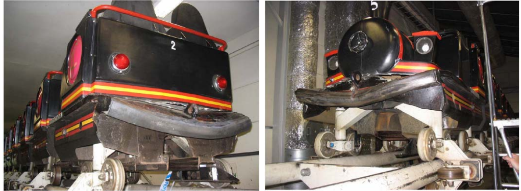
Fig 4. Skador på bakpartiet (tåg 2) och frontpartiet (tåg 5).
