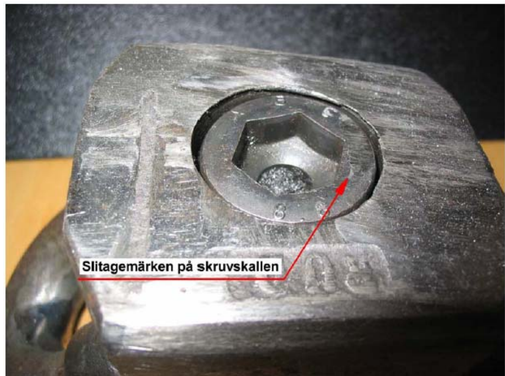
Fig 6. Detalj utvisade ena halvan av det havererade kedjelåset.
