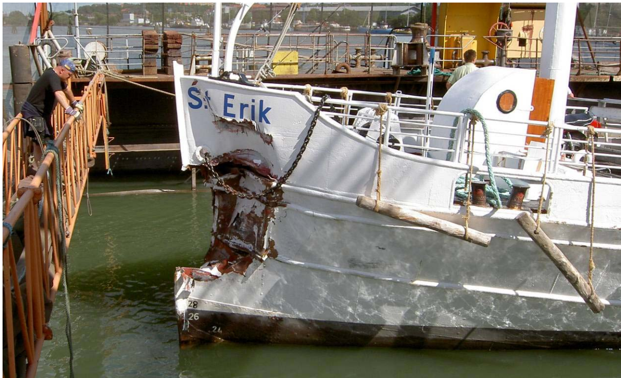
Bild 2. Skadorna på S:t Eriks stäv.
