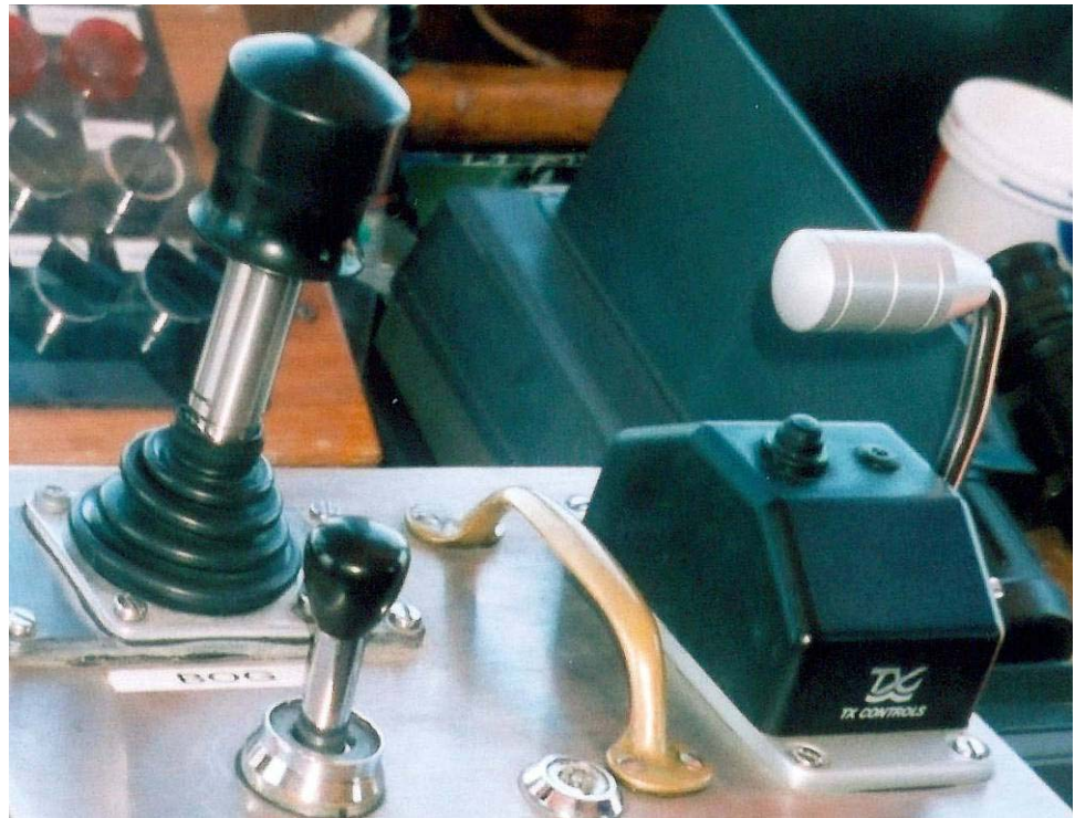
Bild 4. Manöverdonen i detalj. Den övre vänstra spaken är för manövrering av bogpropeller. Den lilla spaken till vänster är fartygets ordinarie styrning. Den krökta spaken till höger är maskinreglaget. På manöverdonet till maskin syns också funktionsknapp och lysdiod.
