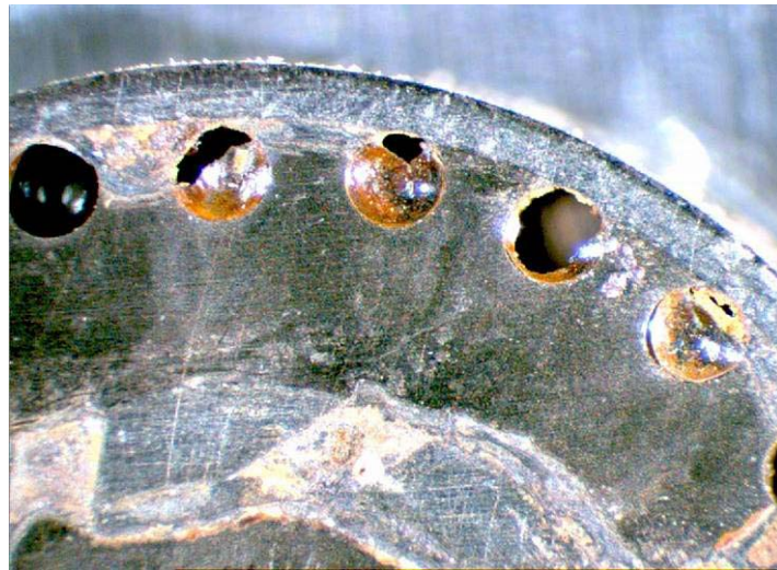
Bild 6. Del av förorenat spridarmunstycke
