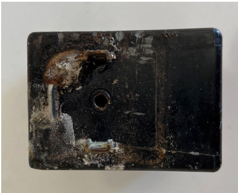
Figur 14. Spolen som tillsammans med kontakt och packning hade haft en IP-klass 65, dvs. varit dammskyddad och spolsäker. Överst, till vänster på spolen är motsvarande brända yta som på kontakten i figur 13. Man ser också spår av intorkat salt på ytorna.
