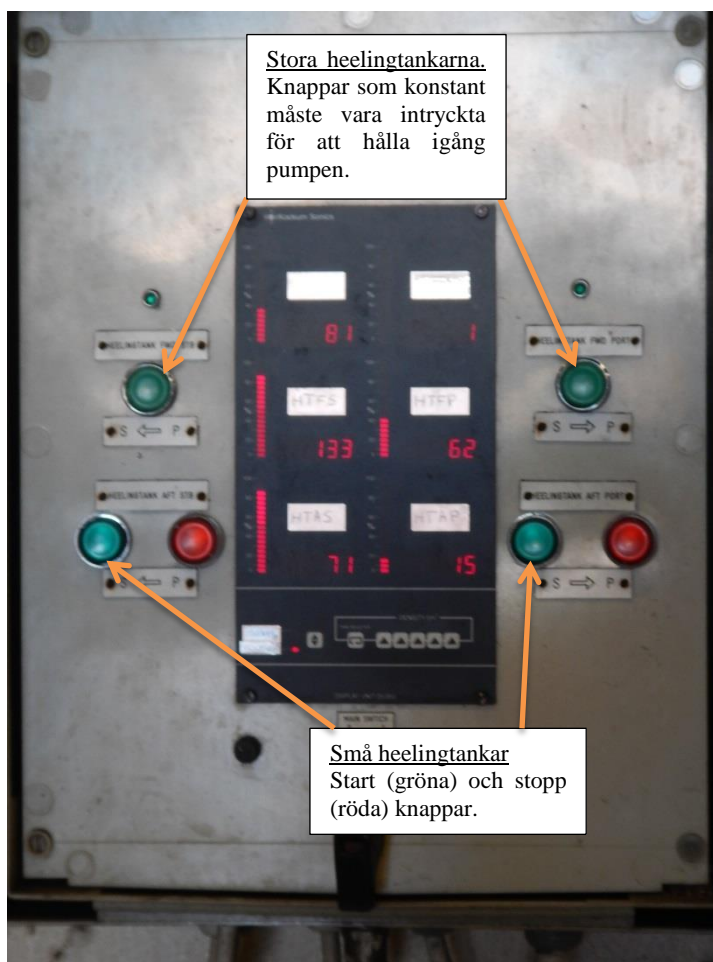
Figur 3. Manöverpanelen för båda heelingtankarna placerad vid förkant på casingen.
