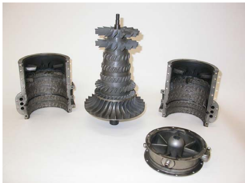
Bild 2. Kompressorns huvuddelar efter demontering.
