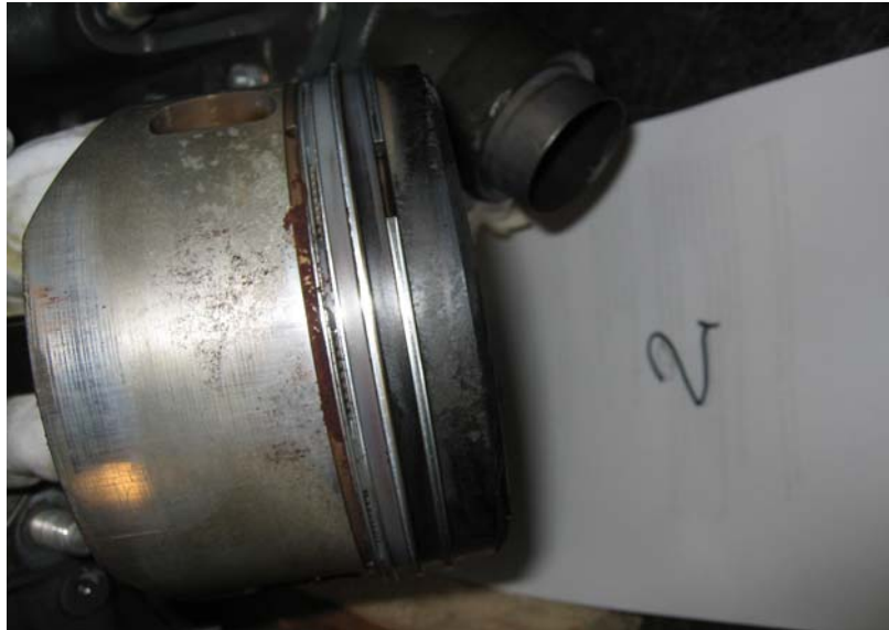
Bild 4. Rost på översidan vid oljeskrapping samt tecken på varmgång i kolmaterialet under ringarna
