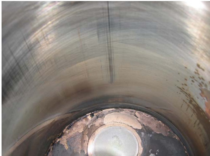
Bild 5. Anlöpning inne i cylinder.
