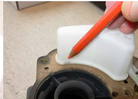
Bild 7. Nötningsmärken på flottör.
