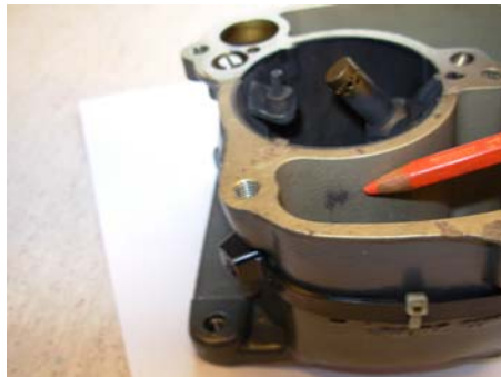
Bild 8. Nötningsmärke i flottörhuset.
