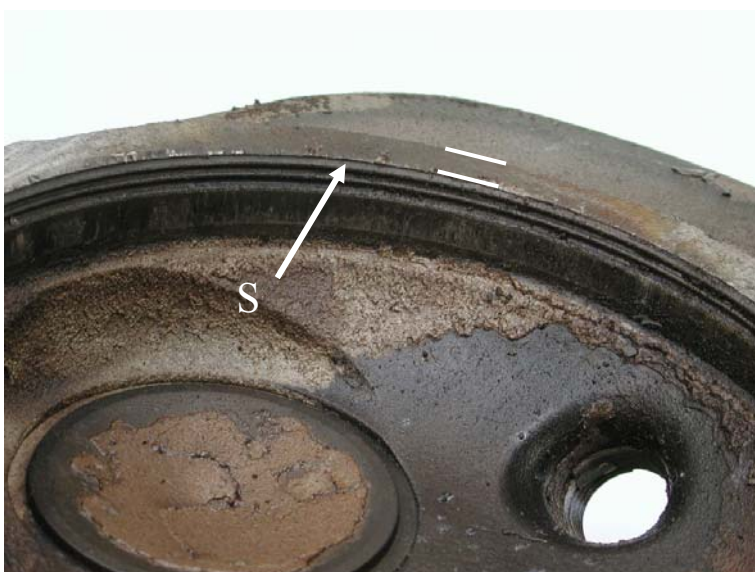
Figur 4. Cyindertoppens övre del med markerad startpunkt (S). Brottytan ligger mellan streckmarkeringen.
