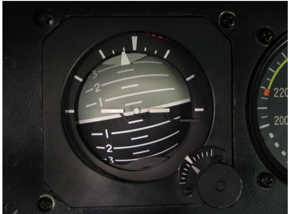
Fig. 10: Reservhorisontgyrot, i överkanten sitter rollvinkelvisaren. Helikoptern bankar här ca 10^\circ höger. Rollvinkelvisaren är horisontrelaterad.
