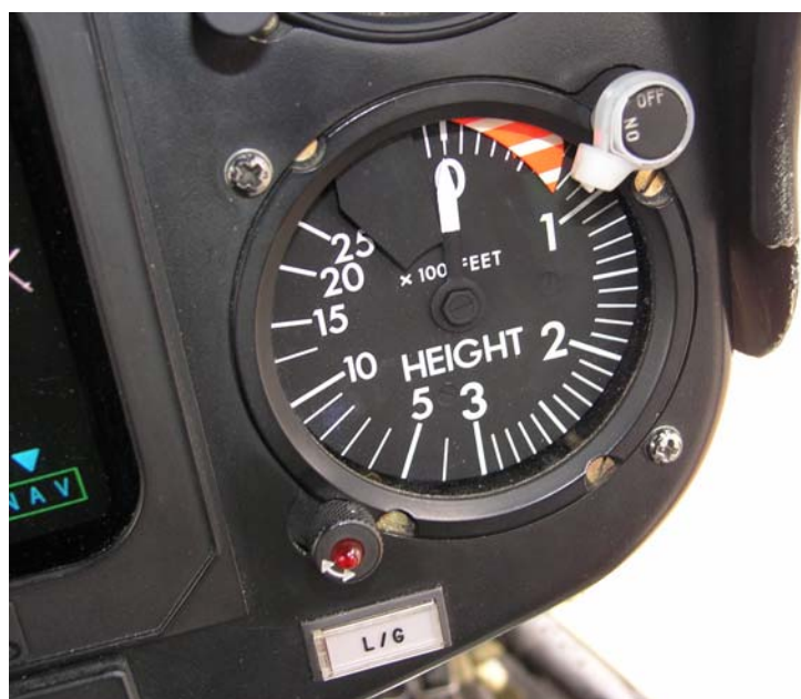
Fig. 12: 1.förarens RHM. Strömställaren står i läge OFF och den röd-vita ”flaggan” indikerar FRÅN. Beslutshöjd (DH) väljs med vredet med röd lampa till vänster ”kl. 7”. Index för DH är bakom ”flaggan”. På bilden syns den icke sanktionerade modifieringen med ett s.k. buntband på ON/OFF vredet.
