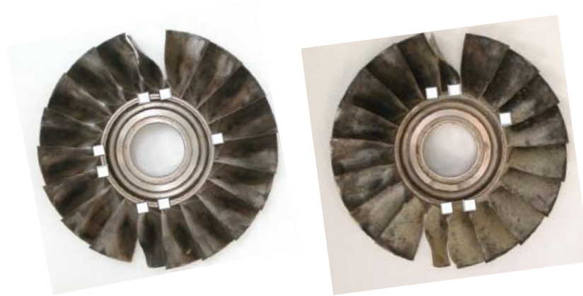
Fig. 22: Höger motors (#2, vänstra bilden) resp. vänster motors (#1, högra bilden) 1.kompressorsteg fotograferad framifrån. På bilden syns de skadade kompressorbladens symmetriska placering.
