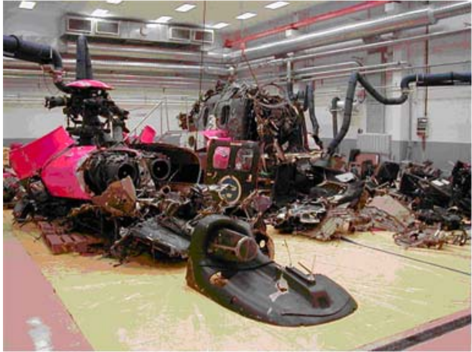
Fig. 3: Helikoptern sedd framifrån. Till vänster ligger motorer, MGB med huvudrotornav och längst fram kåpan med luftintagsskydd för höger motor. Till höger ligger framkropp och bakkropp.
