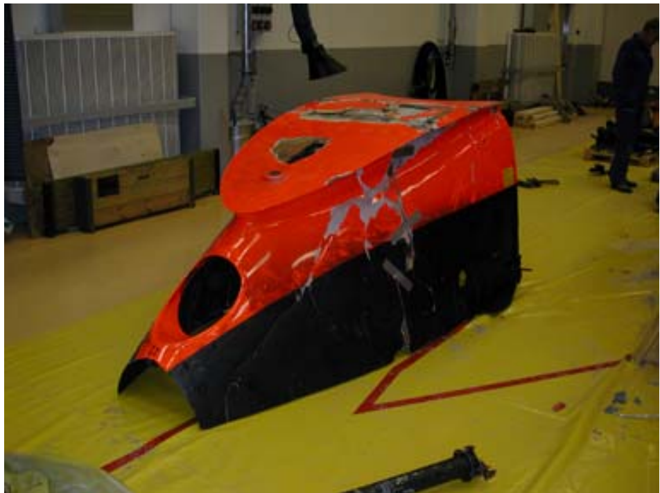
Fig. 4: Den skjutbara växelluckan ”sliding cowling”, täcker området bakom huvudrotorväxeln. Luckan sönderdelades under haveriförloppet.
