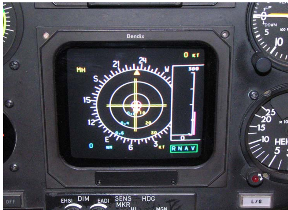
Fig. 9: 1.förarens HSI med hovringsindikator. Presentationen visar att helikoptern står still under förutsättning att gul lampa DOPMEM är släckt. Om vinden är <10 knop och man inte valt CALM SEA kan exakt samma presentation som ovan visas trots att helikoptern kan förflytta sig i någon riktning.
