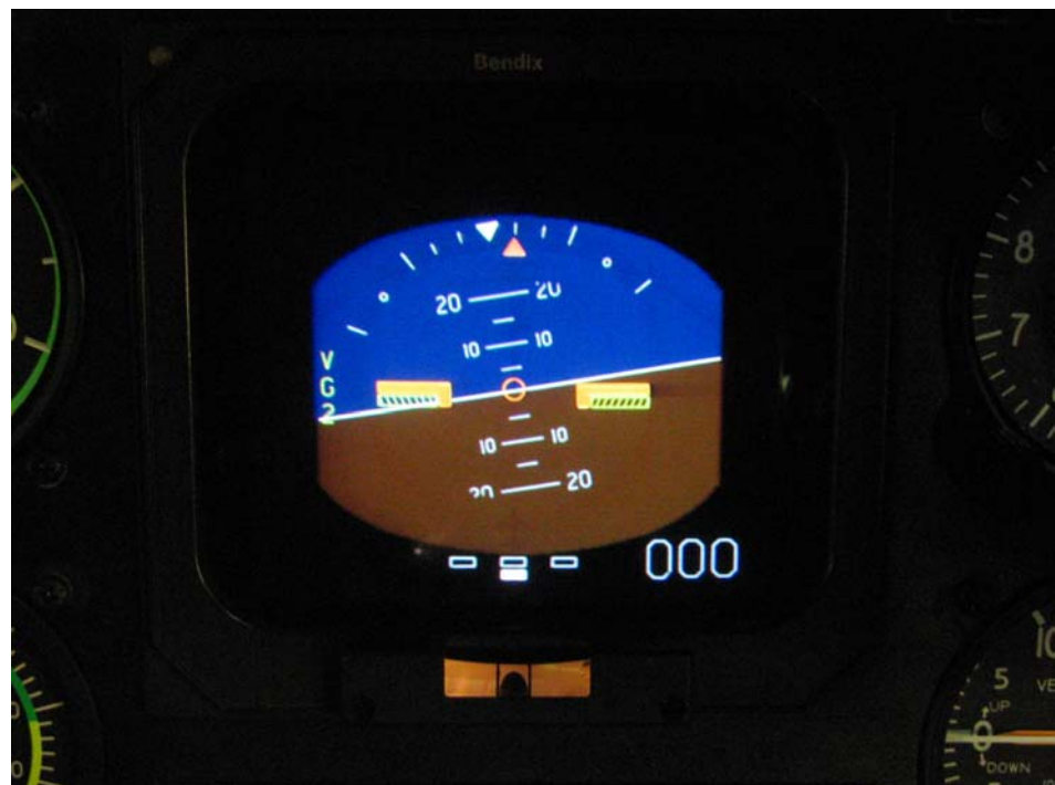
Fig. 11: ADI, i överkanten sitter rollvinkelvisaren. Helikoptern bankar här ca 10^\circ höger. Rollvinkelvisaren är flygplanrelaterad.
