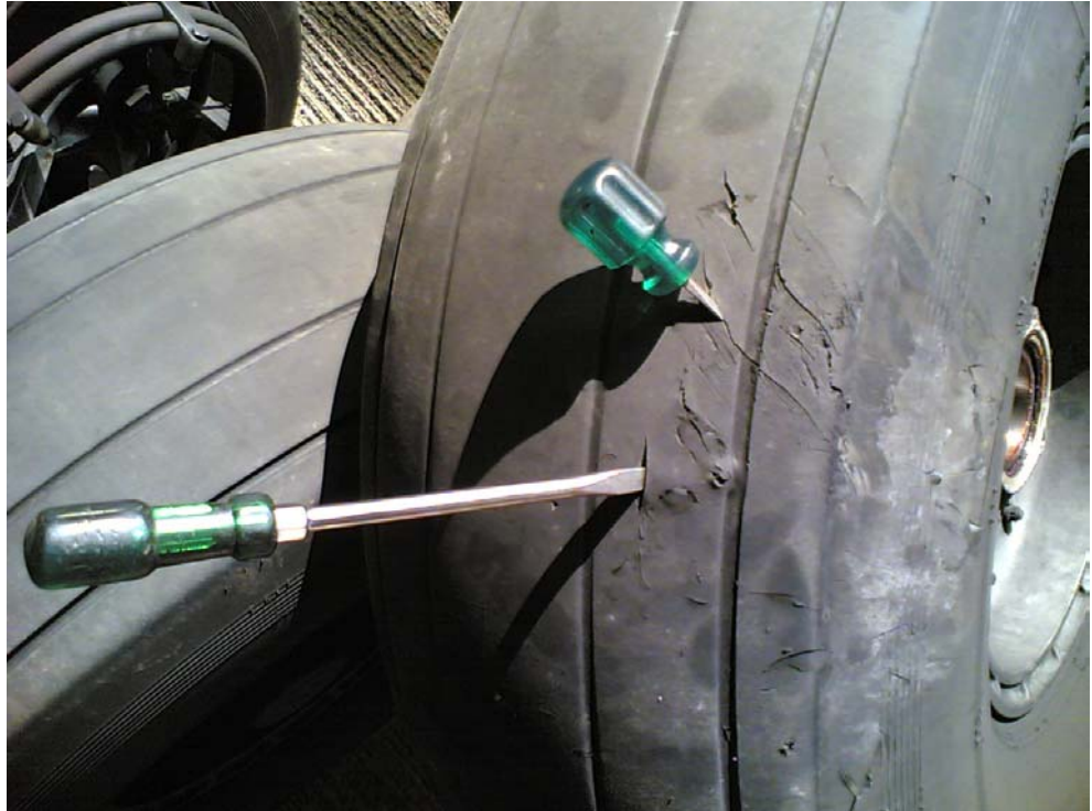
Fig 4. Det skadade däck.
