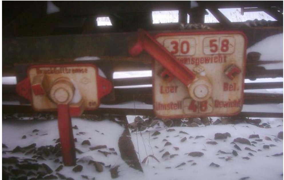
Handtag för avstängning av bromsen (t.v.) och TOM/LAST-handtag (t.h.) på en av vagnarna i Ledsgård efter olyckan. Bromsen är inkopplad. Handtaget TOM/LAST ligger i läge "Leer" (tom). De övre siffrorna visar bromsvikt för tom resp. lastad vagn och omställningsvikten (siffrorna nedanför handtaget) är 48 ton.
