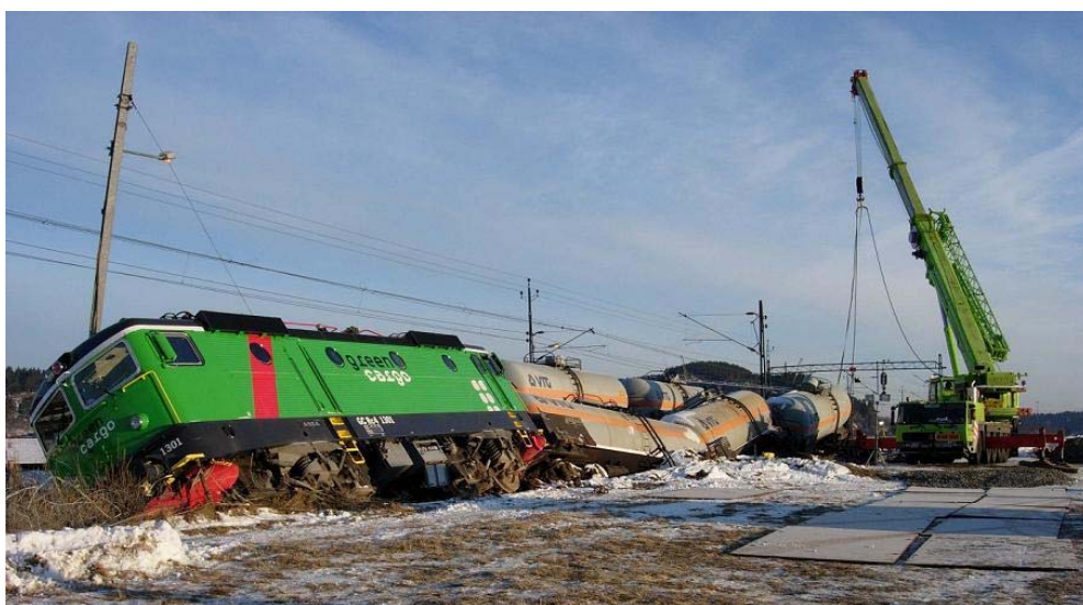
Skissen visar fordonens placering på urspårningsplatsen. Bilden visar loket och vagnarna 1–3 i samband med läktringen av vagn 3.
