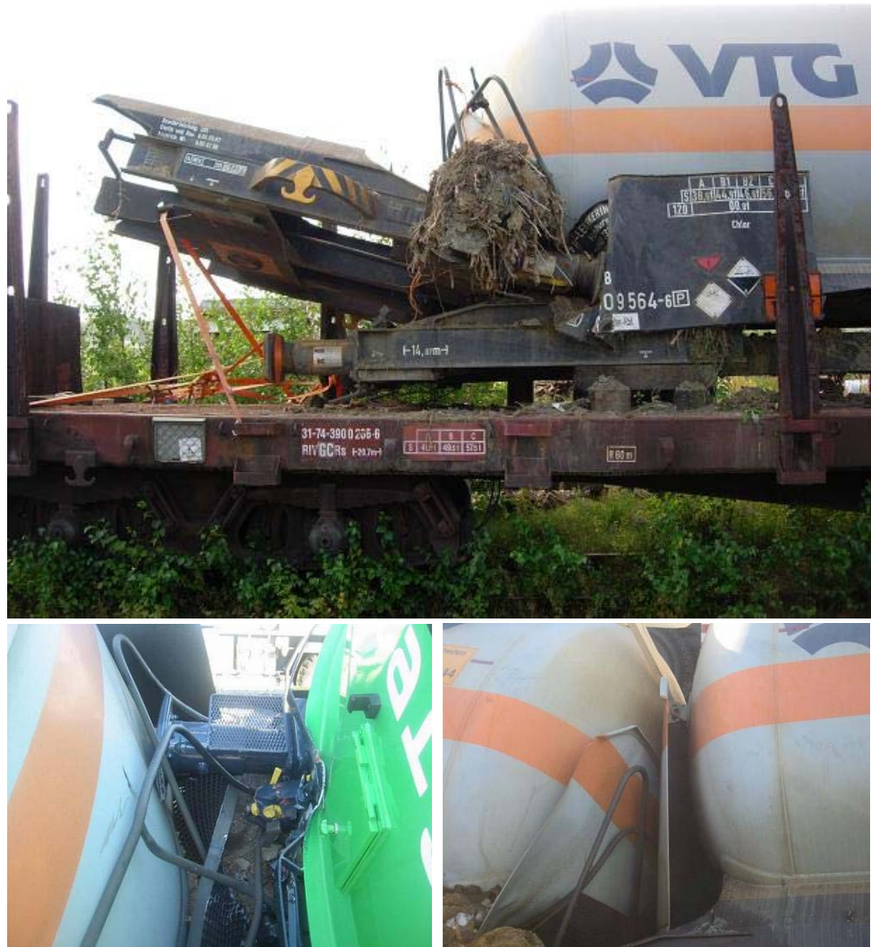
Den övre bilden visar vagn 1 utan boggier och delar av underredet från vagn 2 upplastad på en vagn efter borttransport från Ledsgård. Den undre vänstra bilden visar hur loket och vagn 1 har tryckts ihop mot varandra och den högra bilden visar gavlarna på vagn 2 och 3.
