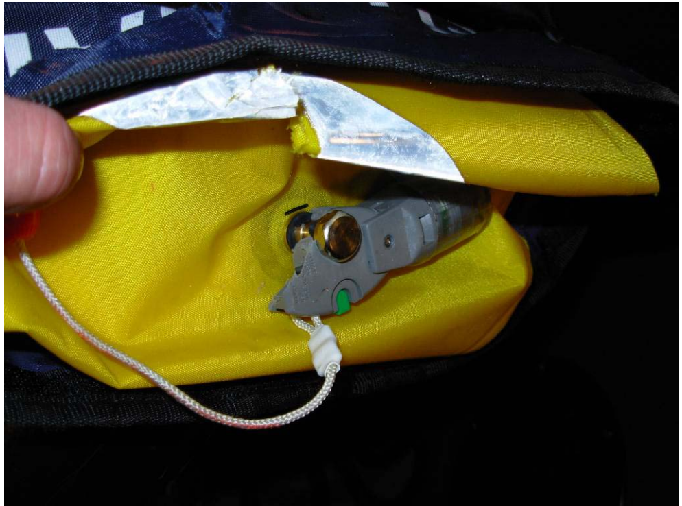
Den sönderskurna västen med sönderbruten utlösningmekanism
