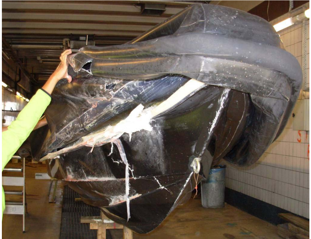
Skador i fören
