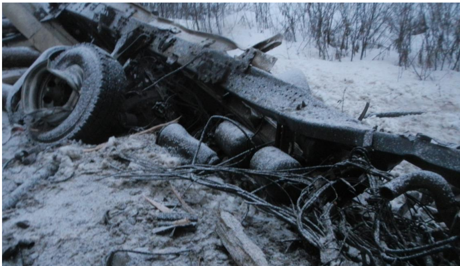
Figur 5. Lastbilens ram. Däcket till vänster i bild visar på positionen på den främre av de bakre hjulaxlarna.
