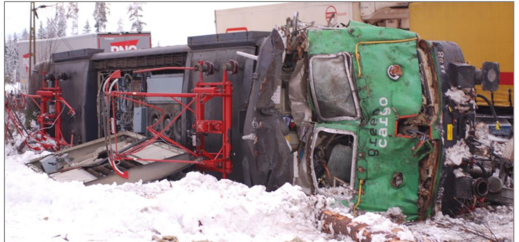
Figur 4. Loket liggande på vänster sida om tågspåret med hytten (närmast i bild) i motsatt riktning mot tågets färdriktning före olyckan.
