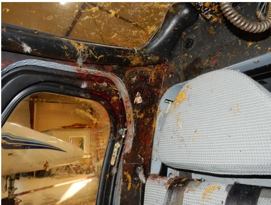
Figur 5. Rester av tjädern vid den plats där den skadade piloten har suttit.
