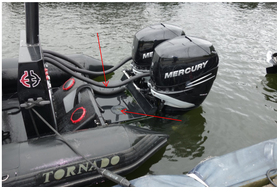
Figur 6. Utrymme för om motorerna (brackets) som inte var vattentätt.
