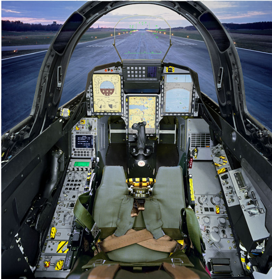
Figur 16. Gripen C cockpit. Navigeringsdisplay i mitten med HUD ovanför och framför front-rutan. Foto: Saab AB.
