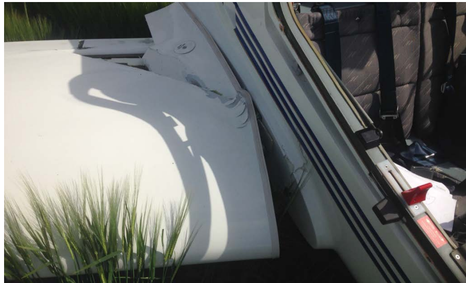
Figur 9. Skador på vingroten. Bild: Gösta Larsson
