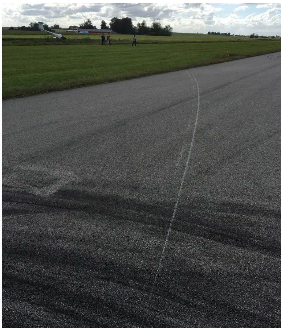
Figur 8. Spår av vänster vingspets som släpat i banan. Foto: Polismyndigheten.
