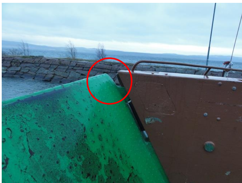
Figur 14. Bilden visar det utrymme mellan färjans påkörningsramp och reling där repet fastnade vid två tillfällen under EXTRACTION.
