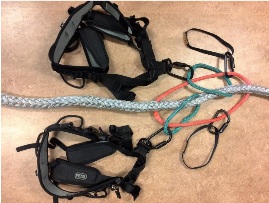
Figur 8. Infästningspunkter i SPIE-rep. Foto Försvarmakten.
