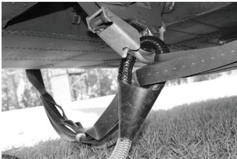
Figur 6. Amerikansk SPIES-lösning enligt USSOCOM 350–6. Detta rep har en polyuretanklädd ögla för direkt anslutning till lastkroken. Säkringsbandet består av fyra loopar. Bild från US Army Field Manual 3–55,93.
