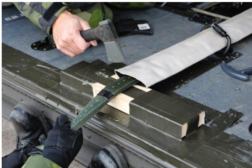
Figur 7. Principbild av SPIE-repets nödfällningsarrangemang på helikopterns golv. Foto: Försvarmakten.
