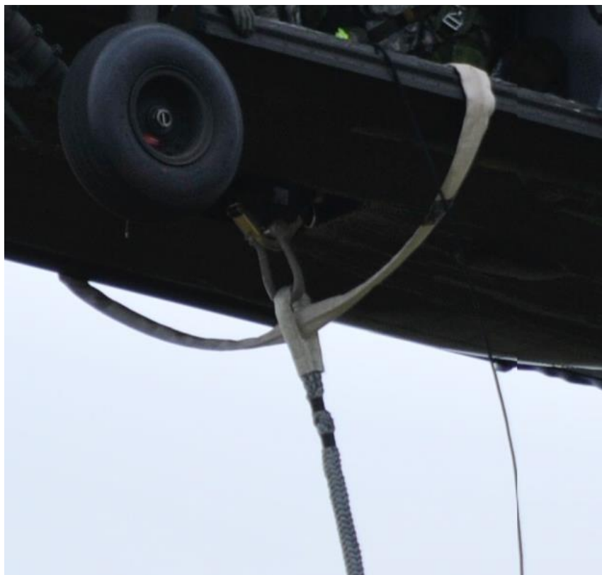
Figur 5. SPIE-repets infästning via Apex-ring i helikopterns lastkrok. Ett säkringsband är trätt genom SPIE-repets ögla. Foto: Försvarmakten.
