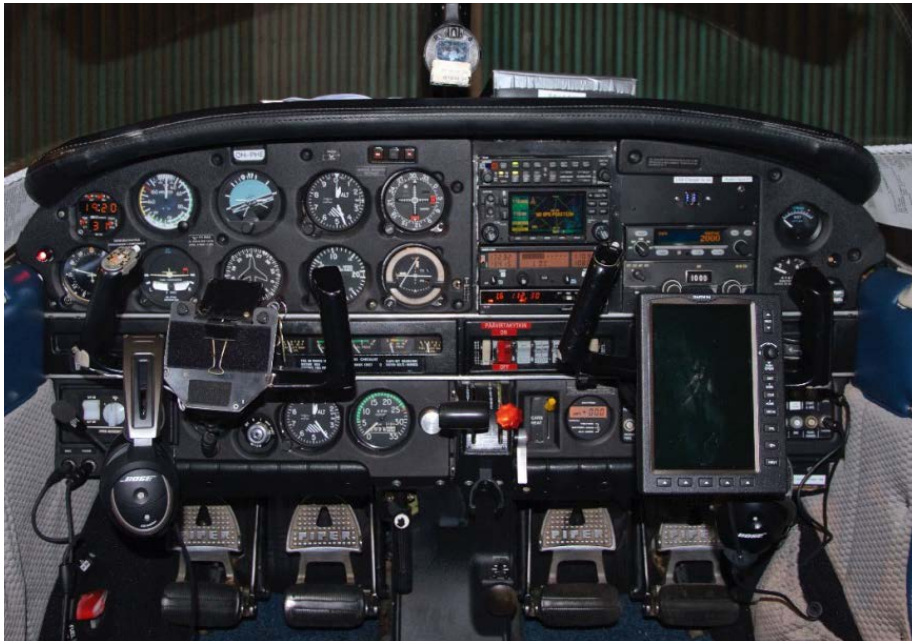
Figur 9. Bilden visar den installerade skärmen monterad på höger styrratt. Foto: Peter Tähtinen.
