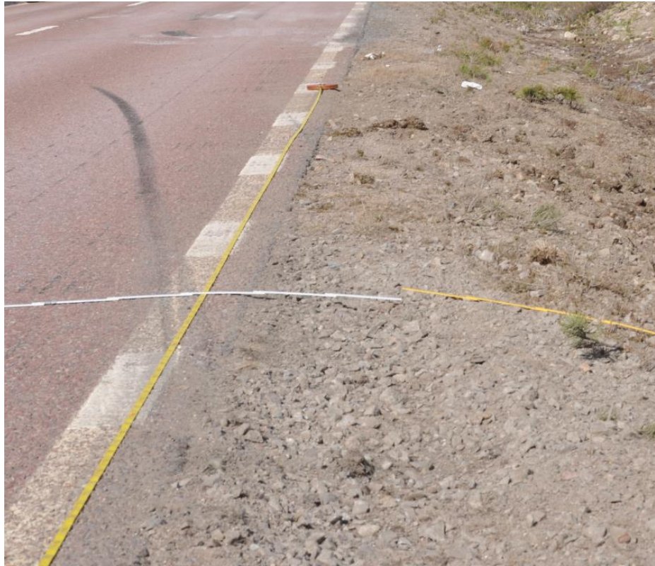
Figur 12. Friktionsspår på vägbanan ca 89 m från nollpositionen.
