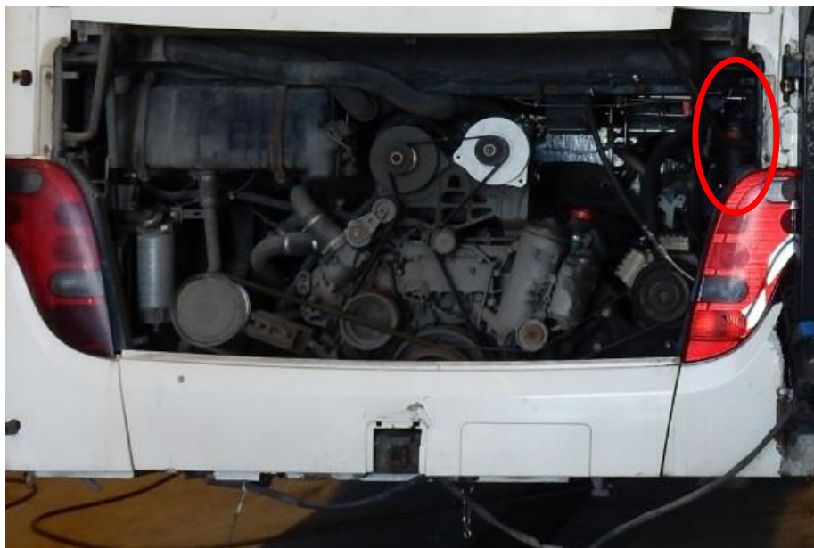
Figur 19. Oljebhållarens placering i bussens motorutrymme.
