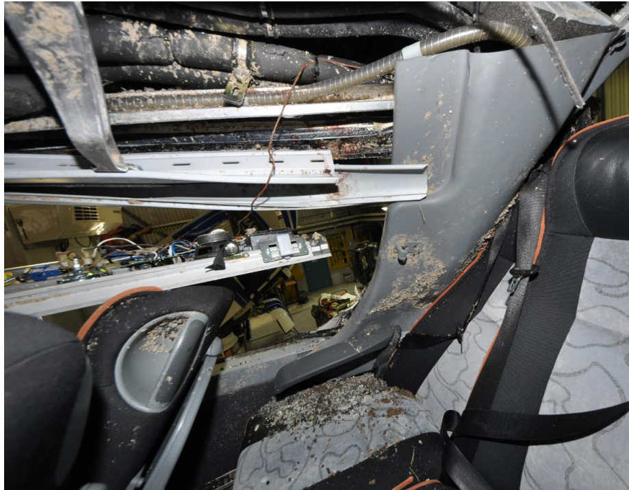
Figur 18. Sätet på det övre planet längst bak på höger sida. Deformationen av takstolpen ledde till en ca 50 cm lång inträngning i passagerarutrymmet.
