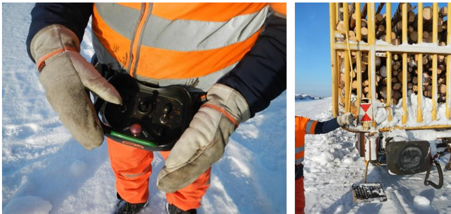
Figur 3. Föraren manövrerar växlingssättet med hjälp av en radiostyrningsdosa ståendes på ett fotsteg i fronten på första vagnen i färdriktningen.
