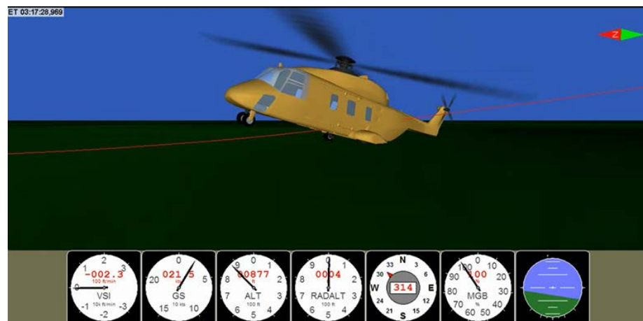
Figur 9. Bild från en animering av FDR-data. Bilden illustrerar helikopterns läge i ögonblicket omedelbart före markkollisionen med instrumenten utvisande från vänster till höger: sjunkhastighet, färdhastighet, barometrisk höjd, radarhöjd, kurs, huvudrotorvarvtal och attitydindikator. Källa: Airbus Helicopters Deutschland GmbH.
