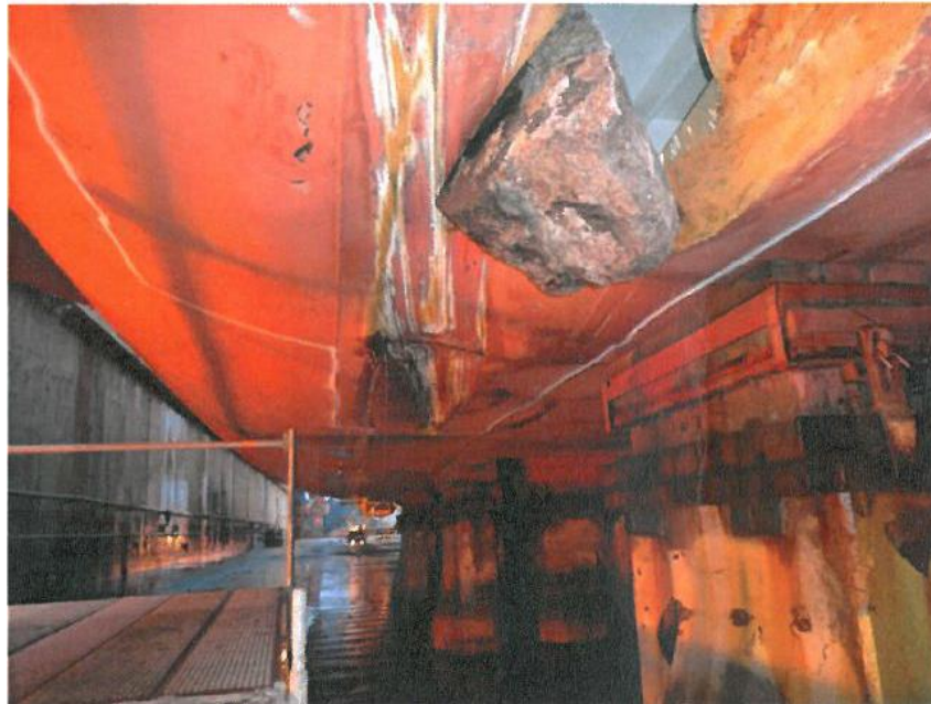
Figur 3. Område nr. 1: Från spant 13 100 till 117, började 9 meter från centerlinjen (CL) och var ca 1,5 meter som bredast. Skadorna bestod i skrapningar och intryckningar och mellan spant 104 och 106 hade skrovet penetrerats in i torr tank nr.7. Foto: Destination Gotland
