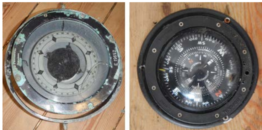
Fig. 8. Till vänster bäringskompassen (fabrikat Weilbach, se också fig. 5) och till höger styrkompassen (fabrikat Autonautic).
