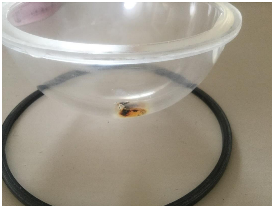
Figur 1. Kupolglas med värmeskada tillhörande den undersökta kompassen. Foto: SG GolfCon
