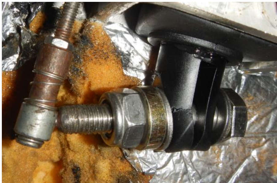
Figur 3. Den skadade ställmotorn. Det spräckta området syns strax nedanför och strax till höger om bildens centrum.
