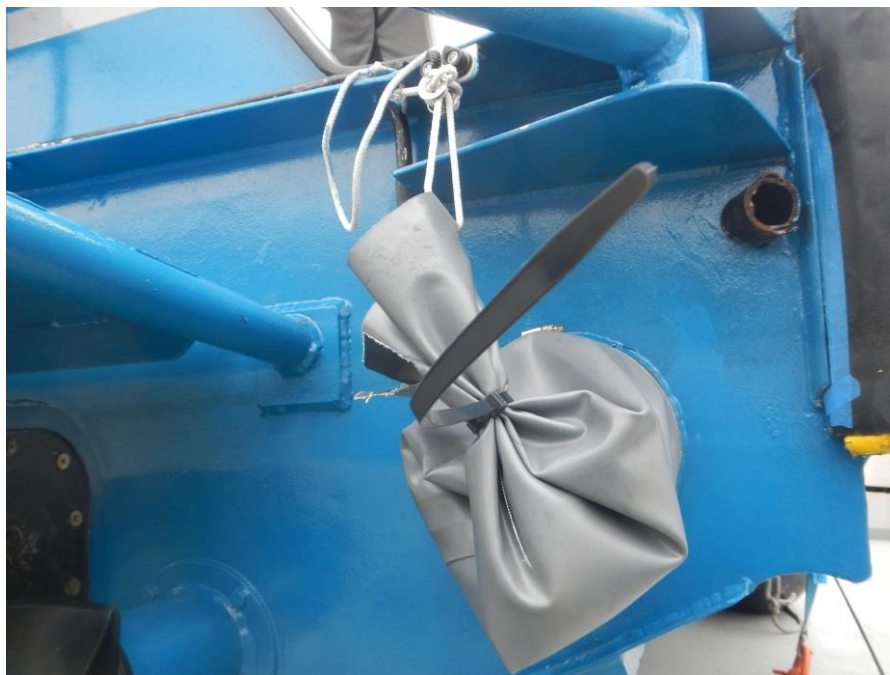
Figur 6. Slangformad plastduk på utsidan av en länsport. Då duken viks av vatten på utsidan hindras vatten att tränga in, medan vatten från insidan tillåts rinna ut då duken sträcks när båten gör framfart. På bilden är duken tillsluten med anledning av bärgningen, dels med den tillhörande linan, dels med det temporärt monterade buntbandet.
