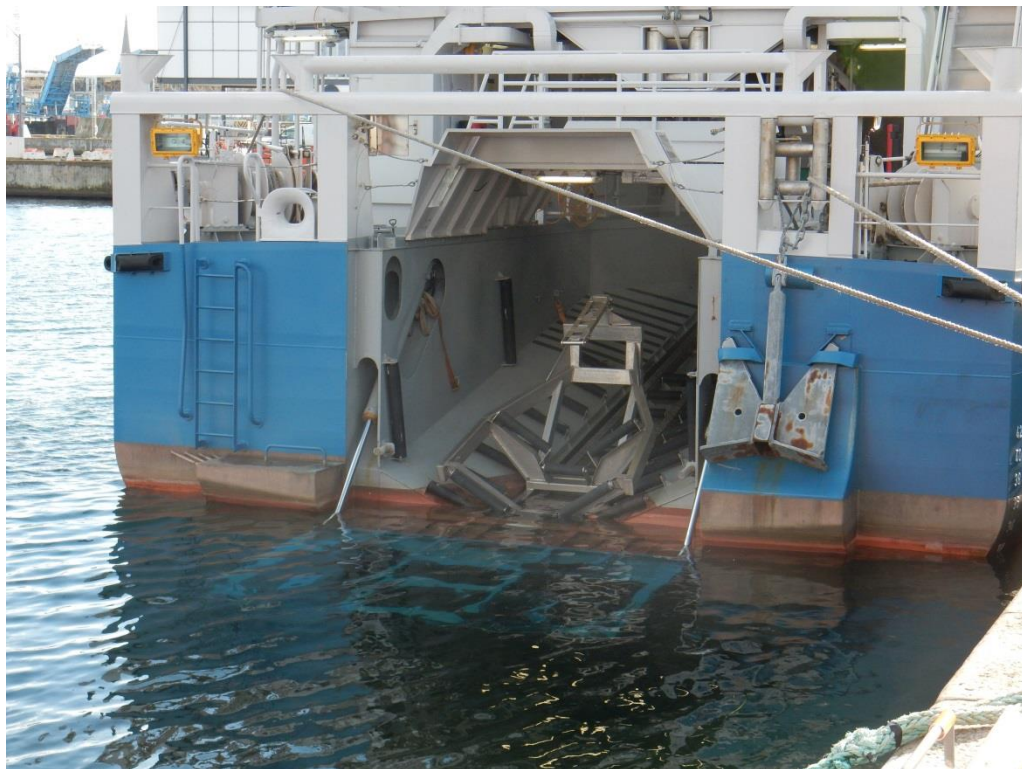
Figur 4. Ramp för beredskapsbåt på KBV 034. (KBV 034 är systerfartyg till KBV 031, moderfartyget till KBV 428).
