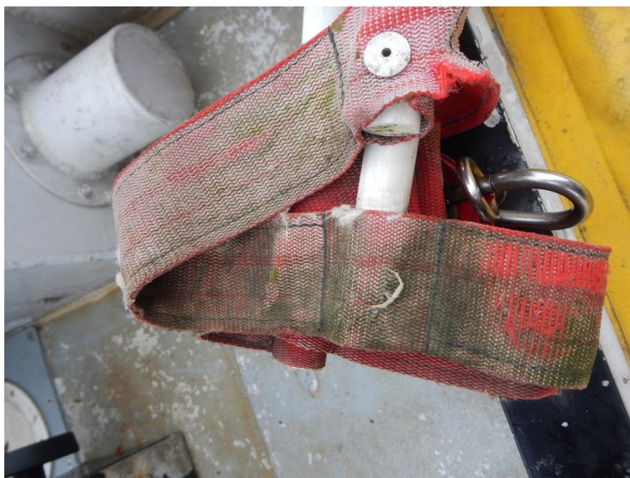
Figur 7. Detalj av räddningsnät som normalt förvaras på insidan av skrovet ner mot durken. På bilden syns att denna del vanligen ligger i vatten.
