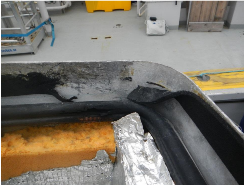
Figur 5. Detalj av motorhuv med sliten gummilist.
