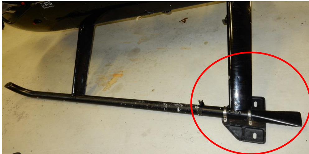
Figur 3. Inringat på bilden av en motsvarande helikoptertyp, men utan nödflottörinstallation på meden, visas en ladda avsedd för landning i snötäckt terräng.
