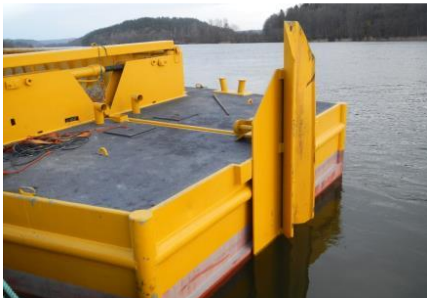
Figur 9. Pråmens akter med stödklyka för skjutbogsering.
