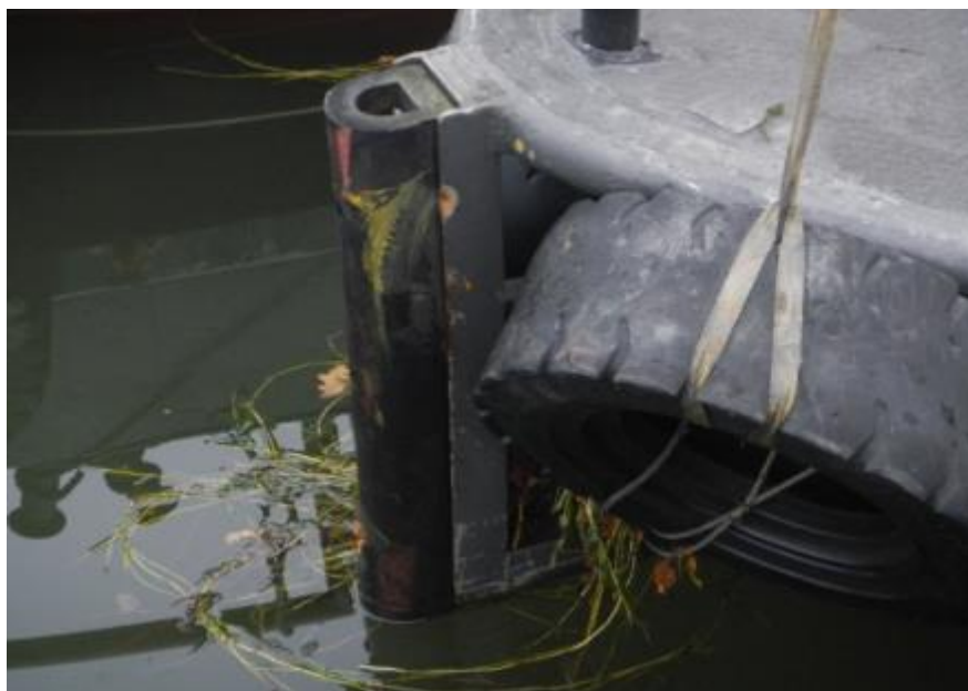
Figur 10. ÖRINGS stävfender för låsning i pråmens stödklyka
