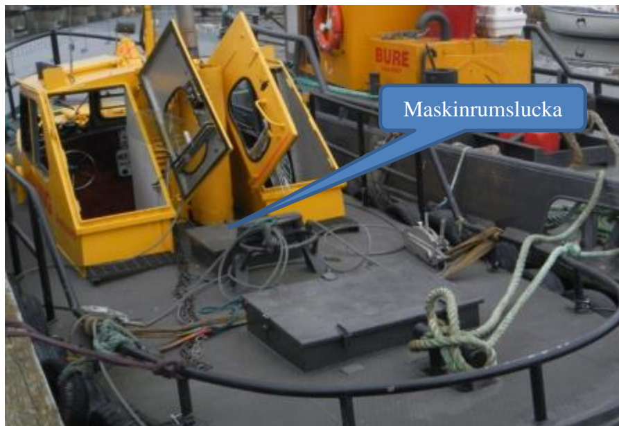
Figur 8. ÖRING – akterdäck med stängd maskinrumslucka och lastrumslucka samt kopplingsvajerarna och vajerlåsens fastsättning i det aktra räcken.
