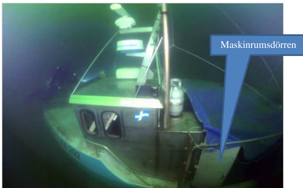
Figur 17. PATRICIAS babordssida. Styrhytten och den öppna maskinrumsdörren. Bild: Richard Kingfelt.
