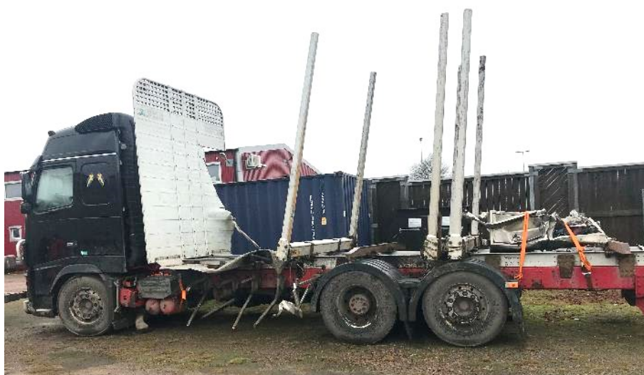
Figur 3 visar lastbilens skador efter kollisionen. Järnvägs- vagnen har träffat i timmerlasten, framför den andra hjulaxeln. Foto: Polismyndigheten
