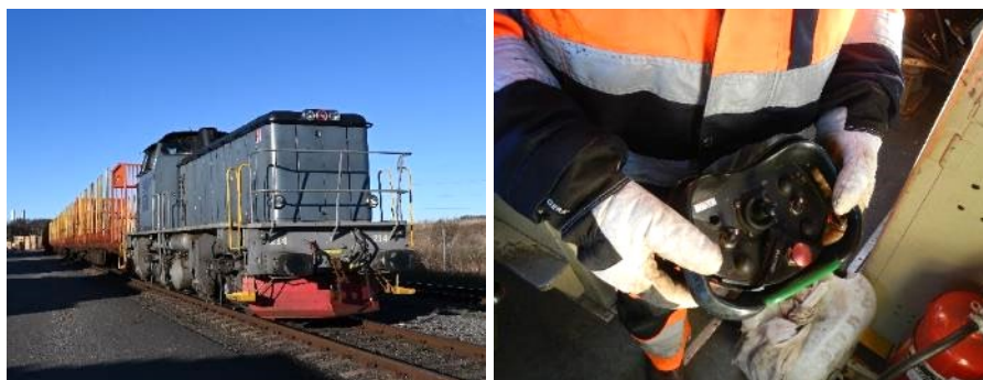
Figur 8 visar det aktuella T43-loket till vänster och fjärrkontrollen till Åkerströmsystemet till höger.
