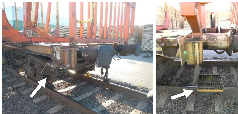
Figur 4 visar till vänster fronten av godsvagnen som kolliderade med lastbilen. Fotsteget som lokföraren färdades på, av SHK markerat med en vit pil, viktes bakåt vid kollisionen. Till höger visas som referens ett oskadat fotsteg på samma vagn typ.
