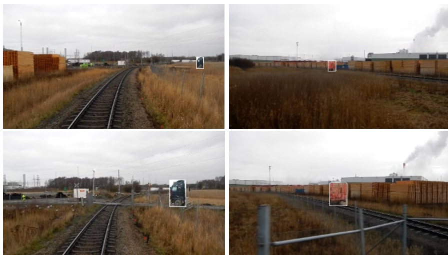
Figur 17 illustrerar SHK:s bedömning av perspektiven för lokföraren och lastbilsföraren 10 sekunder respektive 5 sekunder före kollisionen.
