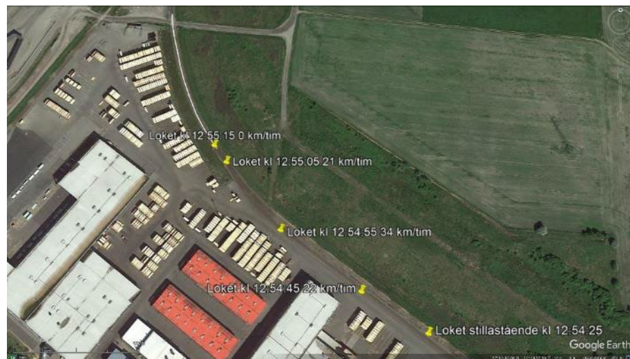
Figur 14 visar en satellitbild med GPS-positioner och hastigheter för loket under förflyttningen mot plankorsningen införda av SHK. Det vita strecket fram till plankorsningen motsvarar 145 meter och avståndet från GPS-antennen till fronten av den första järnvägsvagnen efter kollisionen. Källa: GoogleEarth © Maxar Technologies
