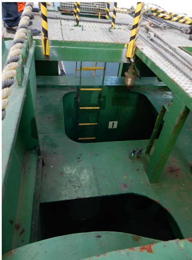
Figur 9. Utrymmet mellan lastrummen och lejdaren på insidan av luckkarmen. Till höger om och nedanför lejdaren, dvs. nere på däck, finns manluckan till utrymmet där värmen regleras. Luckan syns inte i bild.
