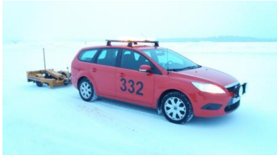
Figur 12. Fordon med bromsvagn Skiddometer BV11. Foto: Lapland Airport.
