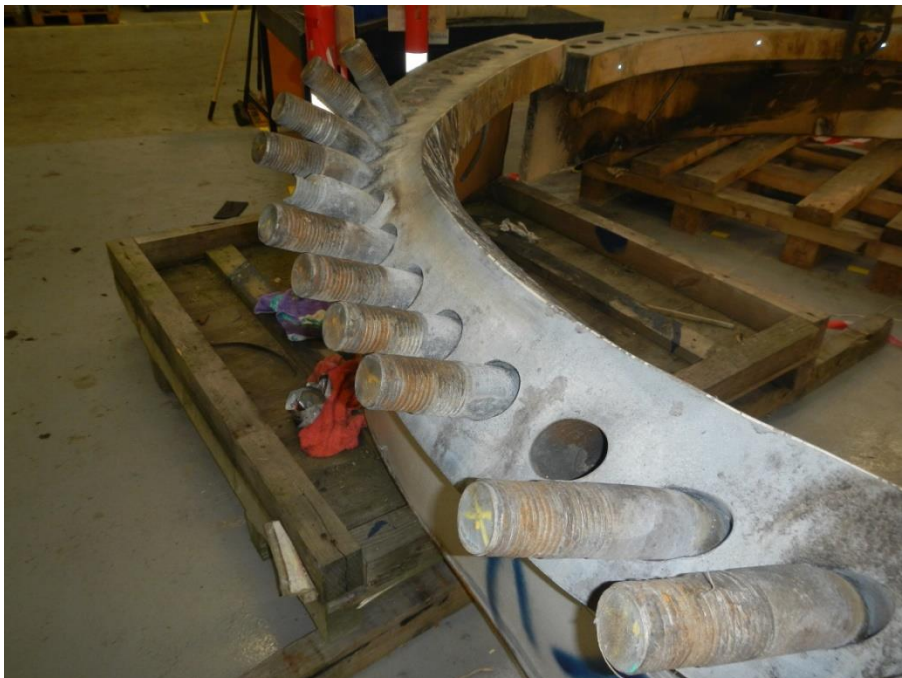
Figur 16. Del av fläns 1, första tornsegmentet, med böjda skruvar som fått sina gängor avskjuvade.
