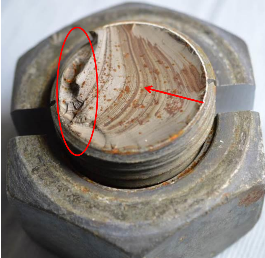
Figur 17. Mutter 1 och skruvrest 1, utmattningsbrottet (se röd ellips) med typiska flodmönster (se röd pil) och ett litet restbrott.
