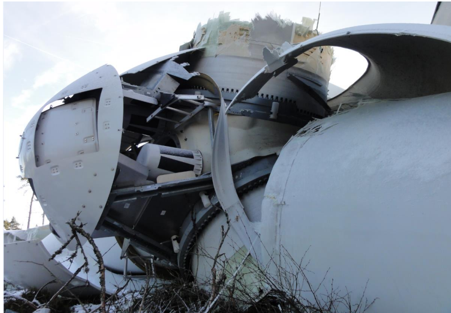
Figur 6. Skador på navet och bladens inre delar.
