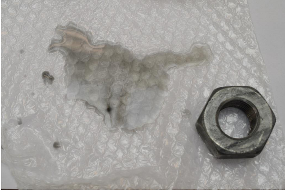
Figur 26. Mutter vars gänga har sprutats med vatten, samt smörjmedelsrester som runnit av.
