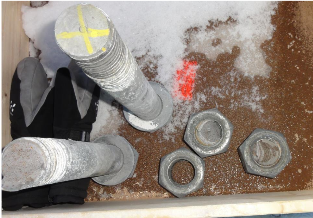
Figur 7. De skruvar och muttrar som omhändertogs av Statens haverikommission. Två av muttrarna hade rester av skruvar kvar.
