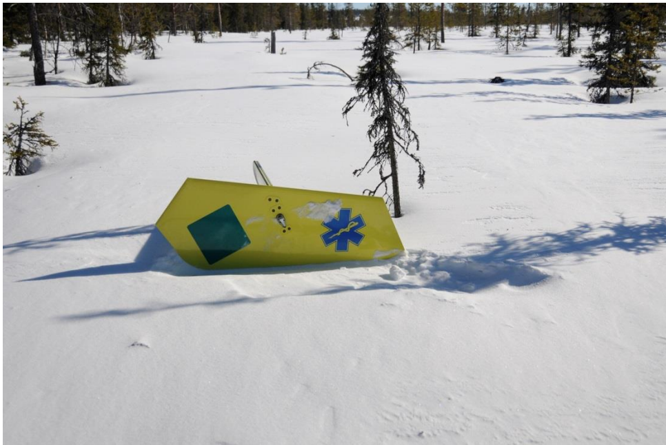
Figur 4. Den upphittade fenan och halva stabilisatorn. Foto: Polisen.
