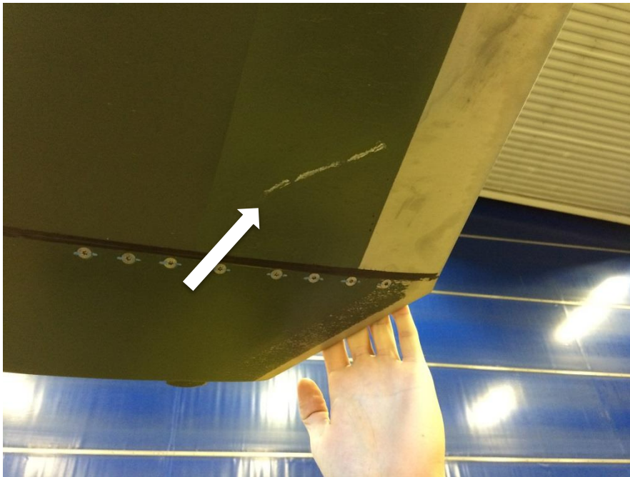
Figur 1. Skrapmärke på undersida av huvudrotorblad. Foto: SHK.
