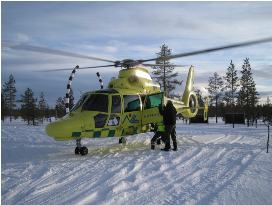
Figur 6. Bilden visar den aktuella lastningen av patienten med helikoptern ”light on wheels” och att detta innebär en betydligt högre lasthöjd än vid normal landning. Fotot är taget cirka 14 min efter att skadan på stabilisatorn hade inträffat, se figur 2. I denna bild kan inget av skadan på infästningen av stabilisatorn skönjas. Foto: Privat.
