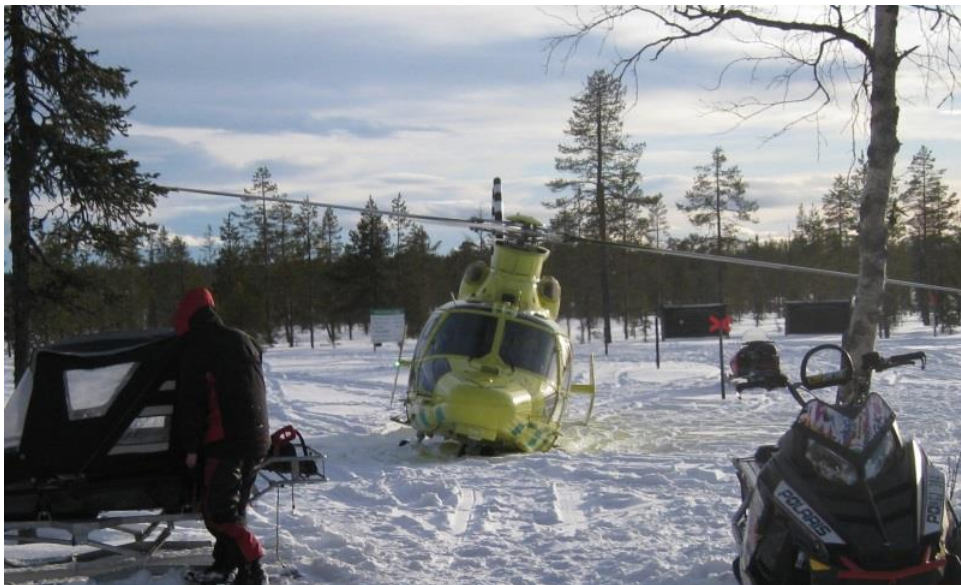
Figur 3. Efter att vänster huvudhjul trängt igenom snötäcket och vänster del av stabilisatorn kommit i kontakt med snön. Notera rotordiskens lutning i förhållande till horisontalplanet. Foto: Privat.
