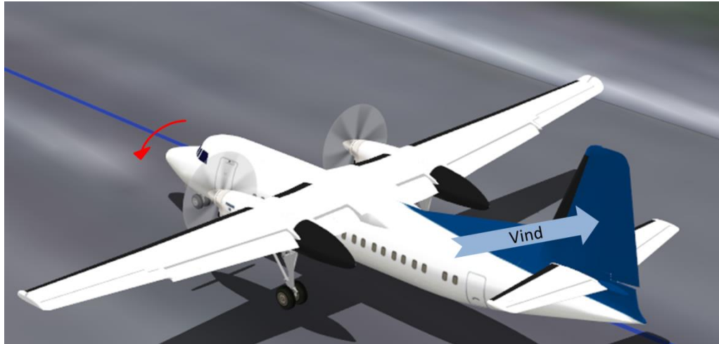
Figur 2. Vindflöjeeffekten. Med tillstånd från CAE Inc (Flightscape).
