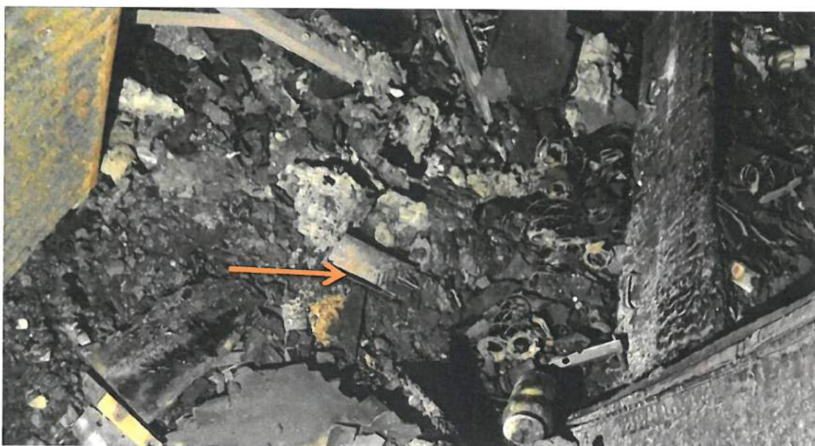
Zdjęcie nr 13. The lower bunk lamp in the conflagration of the cabin floor
