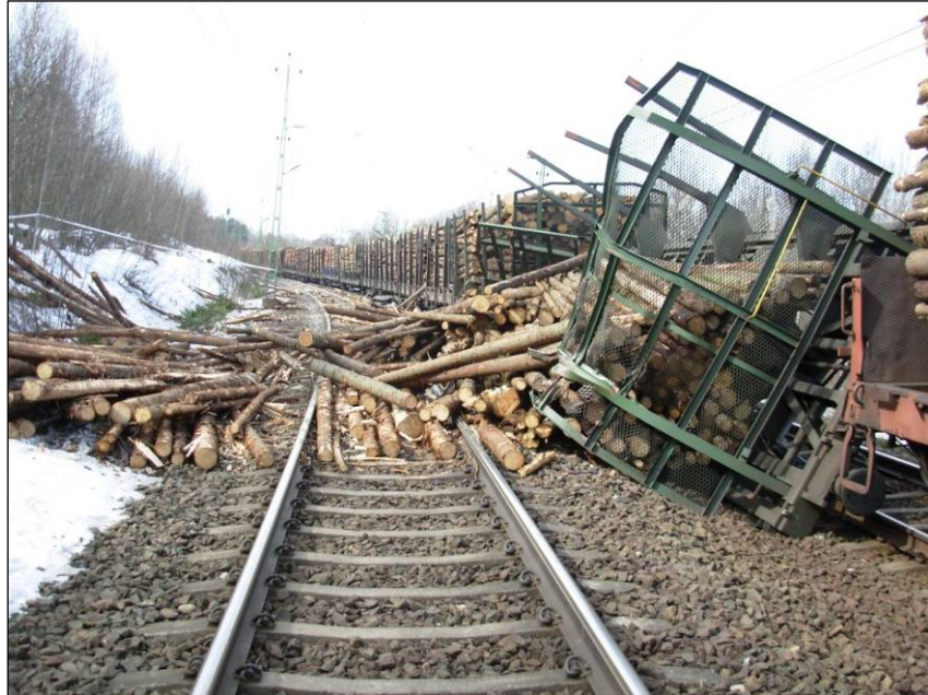
Fig 2. Platsen där resandetåget körde på timret och den välta timmer-vagnen. Gaveln på timmervagnen har deformerats av motorvagnen.
