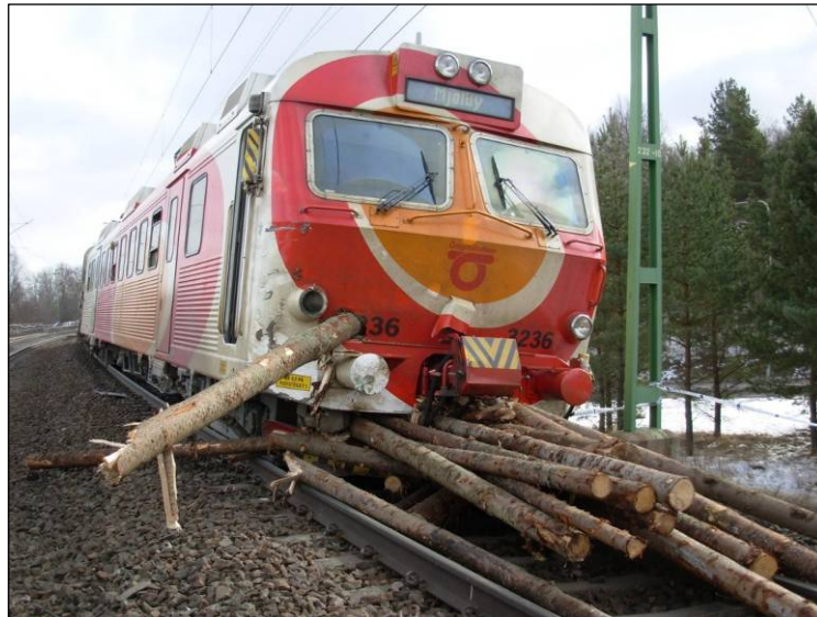
Fig 6. Resandetåget med skadad front och timmer från den vältta vagnen.
