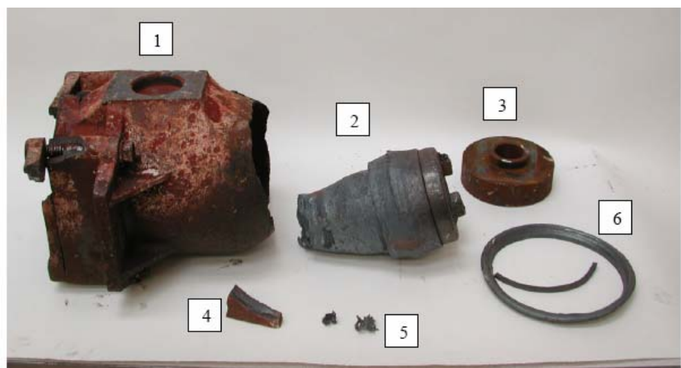
Fig 14: Tillvaratagna delar från Lps-vagnen. Lagerbox (1), avriden axeltapp med ändbricka (2), bricka (3) mellan lagerbox och fjäderpaket samt delar från lagerboxen (4), spånor (5) och lagerdetaljer (6). Foto: Bodycote.
