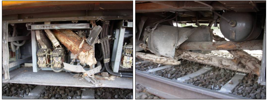
Fig 8. På bilden ovan t.v. syns hur den stock som trängde upp genom golvet har gått genom en apparatlåda i vagnens underrede. Bilden nedan t.h. visar hur det såg ut under motorvagnen.
