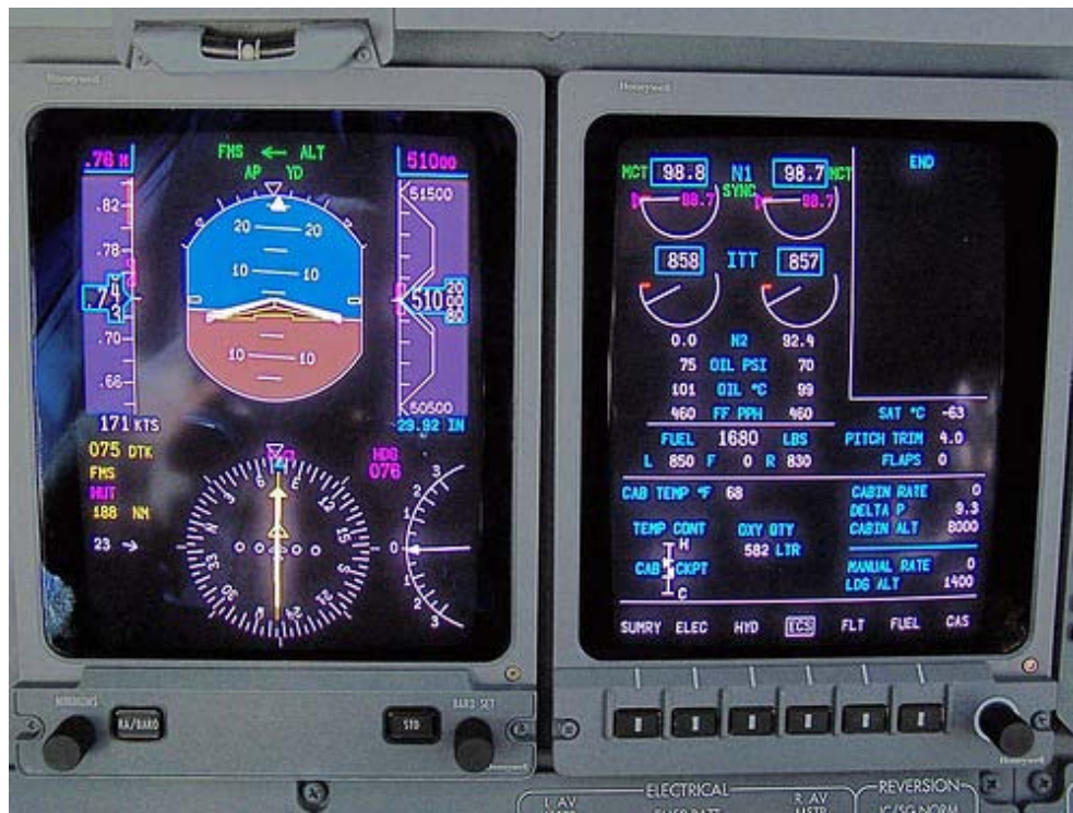
Fig. 11. PFD till vänster och MFD till höger.
