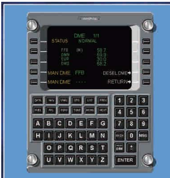
Fig. 10. Manöverpanel för FMS.
