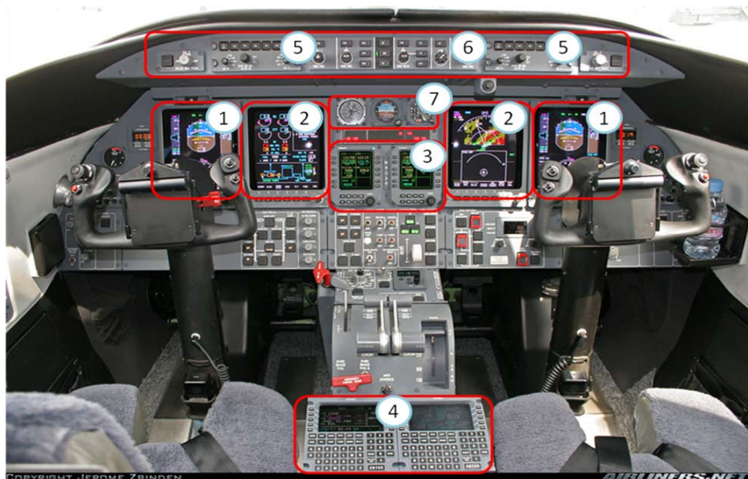
Fig. 12. Förarplatserna i Learjet 40XR. Siffrorna visar: 1 – PFD, 2 – MFD, 3 – EICAS, 4 – FMS, 5 – FD, 6 – autopilot, 7 – elektromekaniska nödinstrument.
