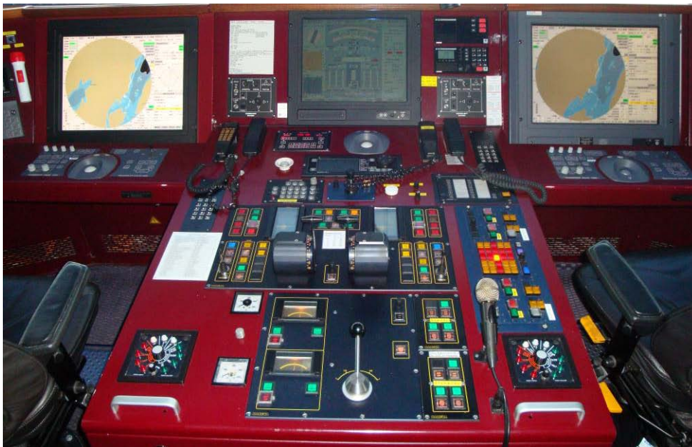
Figur 20 Manöverpanelen på bryggan på Gotland.
