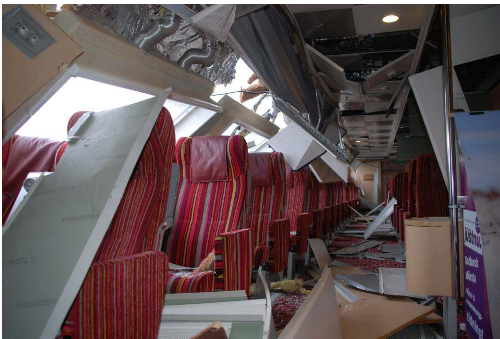
Figur 9 Skador på passagerarinredningen på Gotlandia II däck 5 .
