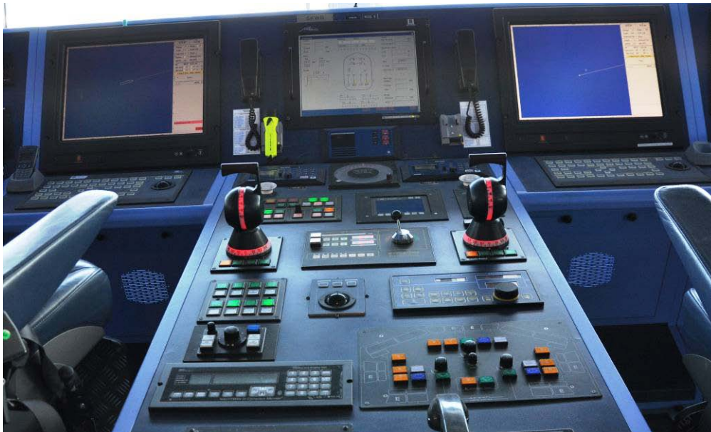
Figur 17 Manöverpanelen på bryggan på Gotlandia II .
