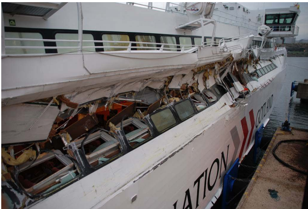
Figur 8 Skador på Gotlandia II styrbordssidan.
