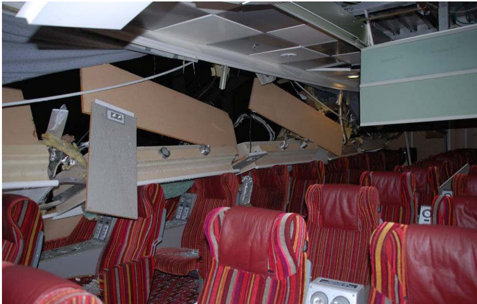
Figur 10 Nedfallna takpaneler i passageraravdelningen på Gotlandia II däck 5.
