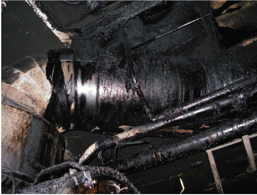
Figur 8 Intryckning under däck (överst i bild) och avgasrör med oljebeläggning.
