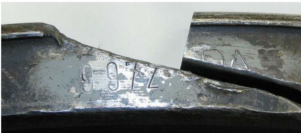
Fig. 4 Den havererade hjulringen på växellådssidan, efter putsning och sammanläggning av delarna – charge 9972 DA.
