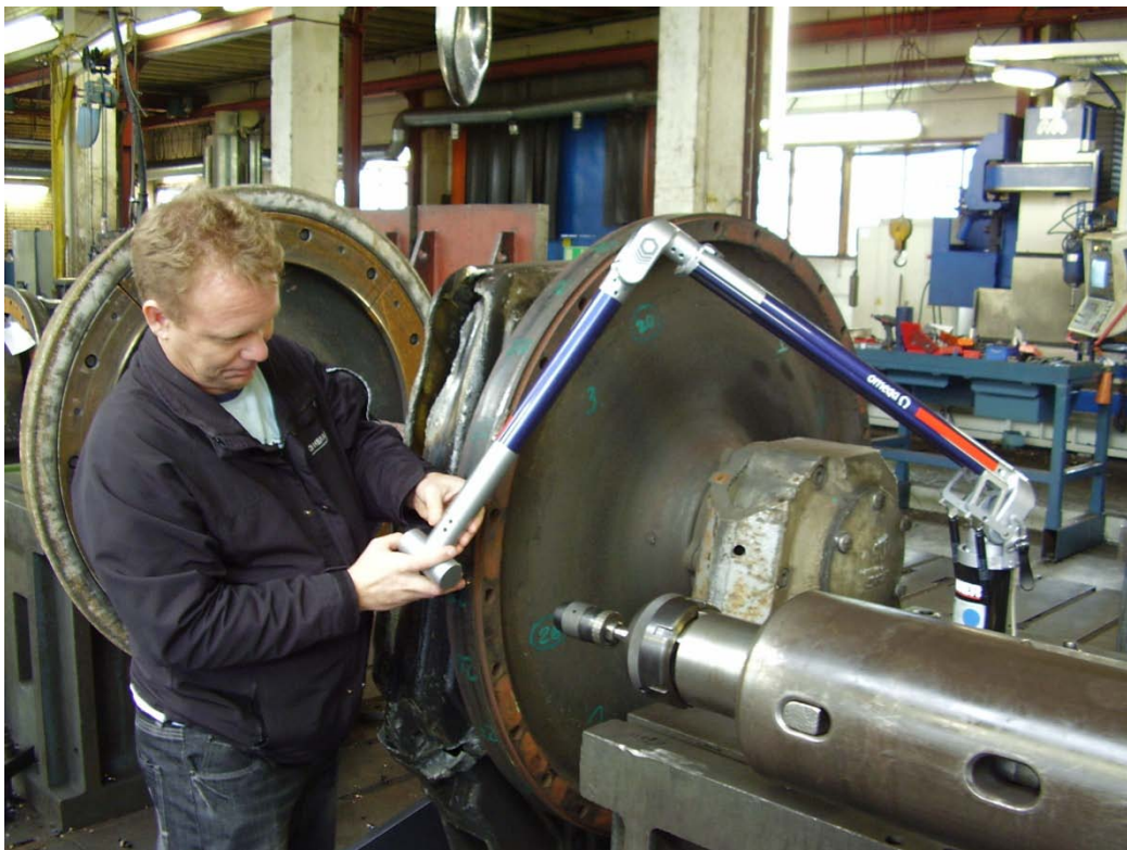
Fig. 18 Diametermätning med ett portabelt mätinstrument ROMER modell Omega 2025. Mätnoggrannheten är enligt kalibreringsprotokollet angiven till \pm 0,068\text{mm} .
