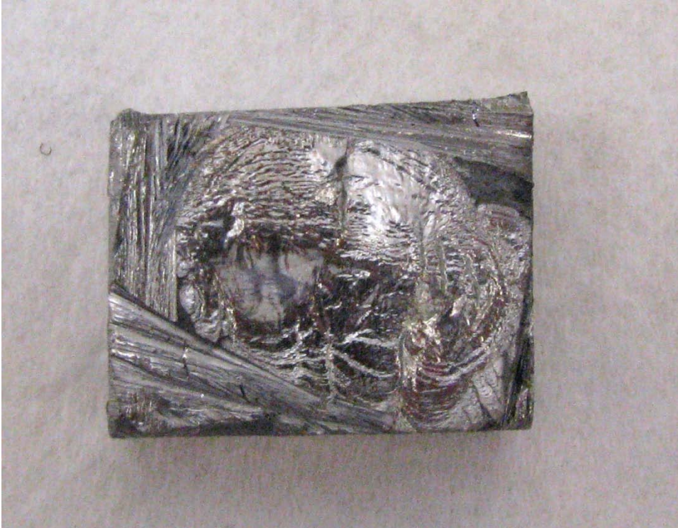
Fig. 16 Motstående hjulring. Utmattningsbrottyta med kraftig nötning.
