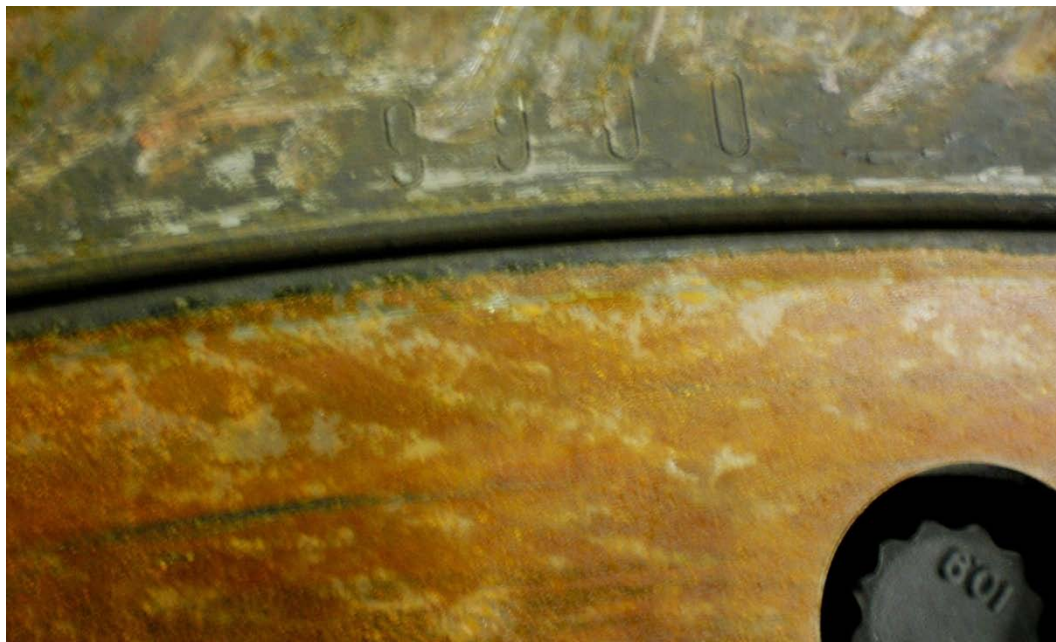
Fig. 5 Märkning på hjulringen på icke växellådssida, skadad av skrapmärken - charge 9900. Signaturstans saknas.
