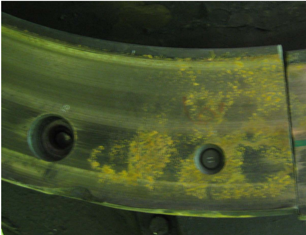
Fig. 22 Figuren visar bromsskiveskruvarna nr 10 till vänster (skruvskallen saknas) och nr 11 till höger (monterad åt andra hållet - också utan skruvskalle).
