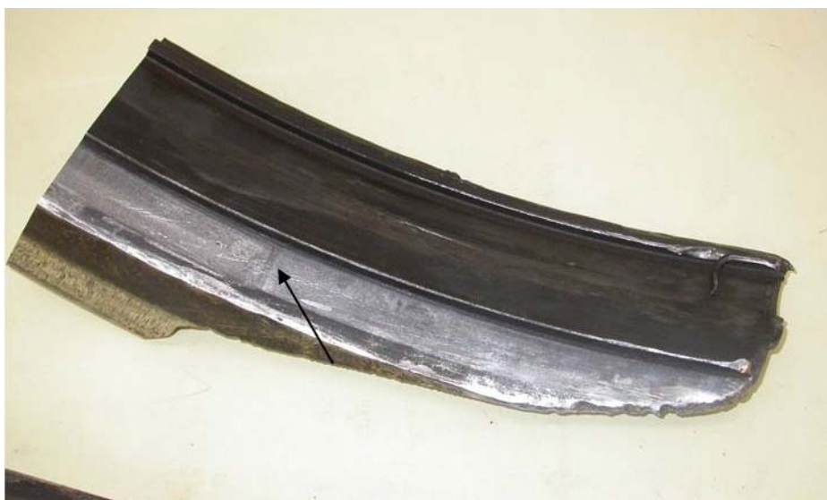
Fig. 26 Märke från skarv mellan två bromsskivor.
