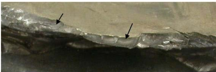
Fig. 14 Närbild av inramad brottyta i figur 13. Markerad yta visar utmattning som växt från löpbanan och inåt.
