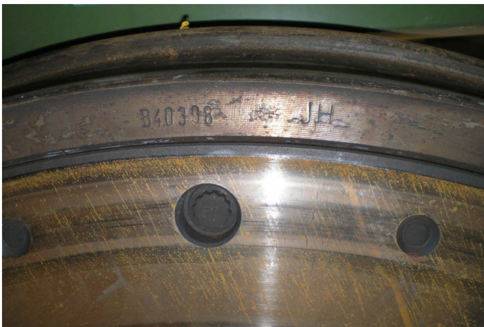
Fig. 28 Chargemärkning på det andra hjulparet i den urspårade boggin till Rc6 1348. Märkningen B40398 JH, visar att ringen är tillverkad av Bonatrans, som använder ett femsiffrigt nummer föregått av B, och signerad av Euromaints operatör JH i Örebro.
