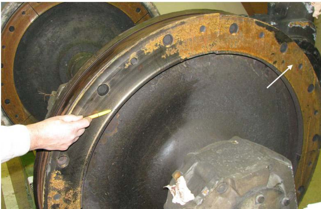
Fig. 17 Handen och pennan markerar positionen för de körnslag som finns på både hjulstomme och bromsskiva medan den vita pilen markerar den identifierade positionen för hjulringsbrottet. Av bilden framgår också att hjulen varit försedda med fyrdelade bromsskivor, se skarvarna på båda hjulen.
