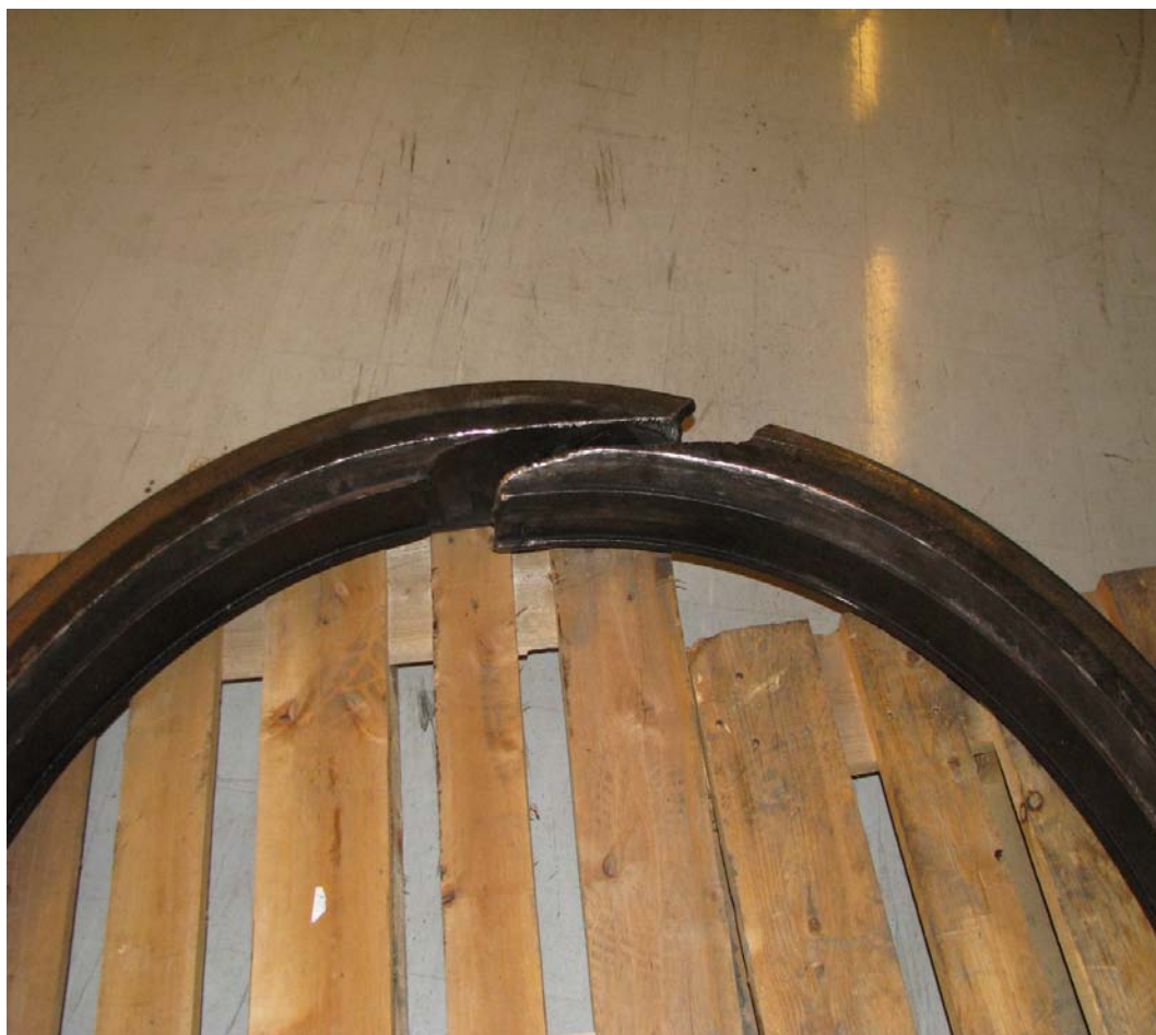
Fig. 10. Bild på den havererade hjulringen och brottet.
