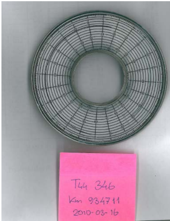
Fig 21. Skiva från färdskrivare i lok 346.
