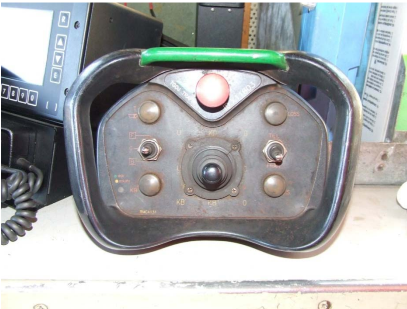
Fig 26. Manöverdosa för radiostyrning av lok. Dosan på bilden hör till ett annat lok och järnvägsföretag än det som var aktuellt i händelsen. Med spaken i mitten kan föraren köra och bromsa loket. Med den lilla omkopplaren till vänster om spaken, ändras körriktningen, framåt eller bakåt.
