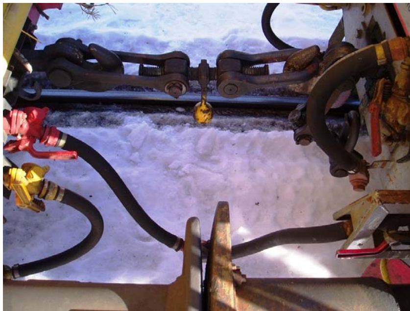
Fig 10. Avstängningsventiler (kikar) och slangar mellan vagn och lok.
