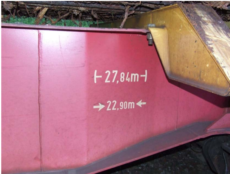
Fig 4. Längden på en Laaps enligt märkning på vagnssidan. Längden är 27,84 m över buffertar och 22,90 m mellan yttre hjulpar.
