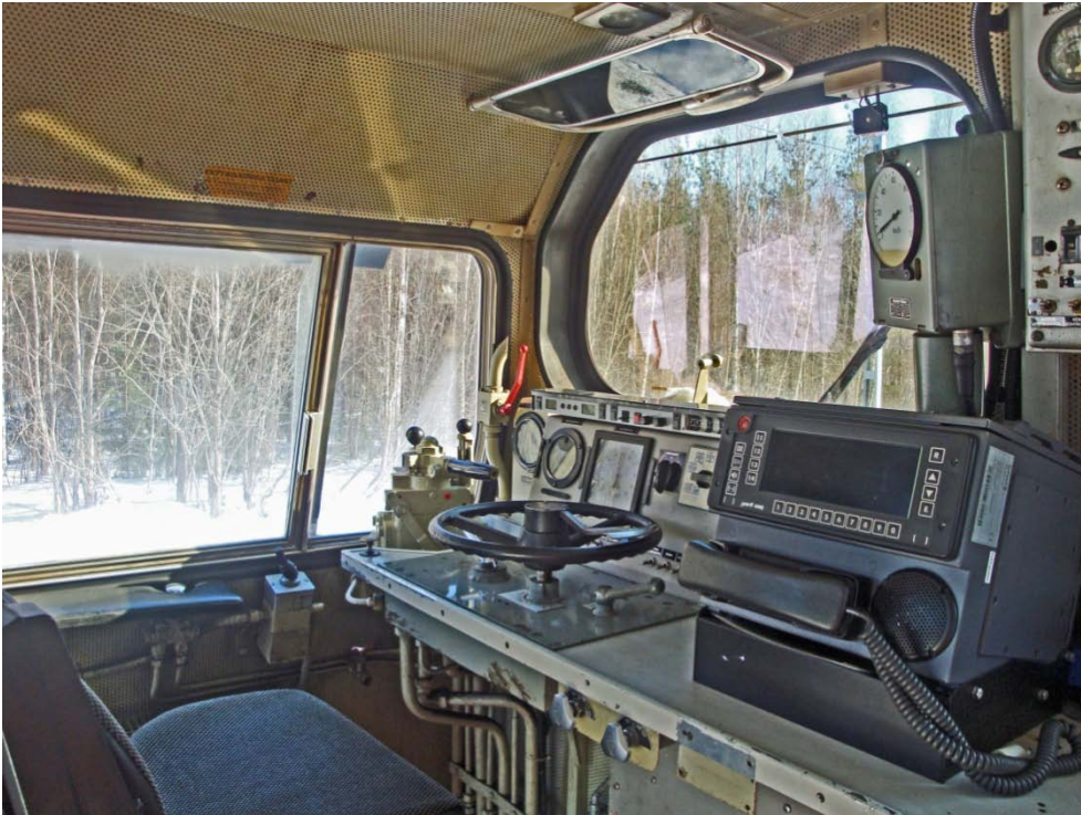
Fig 25. Förarplats i lok typ T44 med manöverreglage. Med ratten i mitten reglerar föraren pådraget. Det stora handtaget snett ovanför ratten är huvdbromskontrollen med vilken föraren manövrerar huvdbromsen. Med den lilla spaken alldeles under sidofönstret ovanför förarstolen kan föraren manövrera direktbromsen, vilken enbart bromsar loket.
