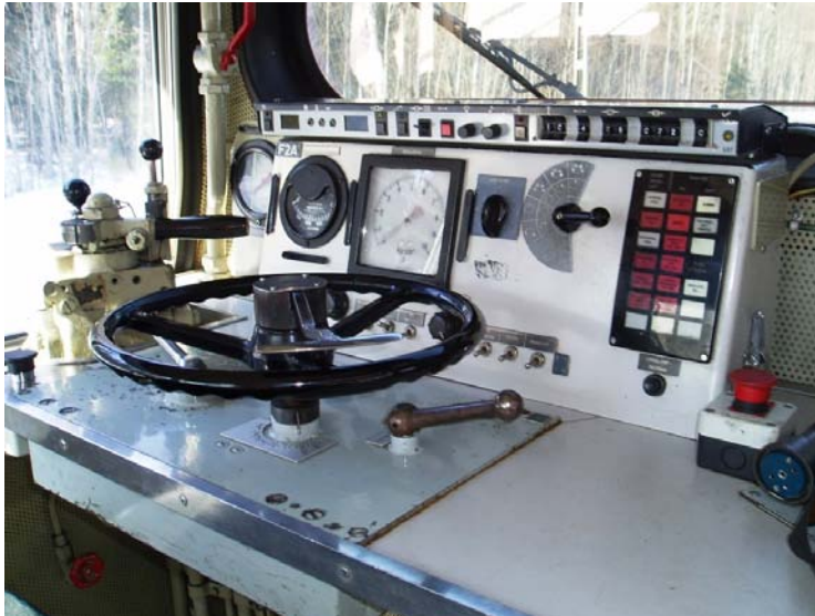
Fig 16. Förarplats (med huvudbromsventil till vänster i bild) varifrån föraren körde tåget.
