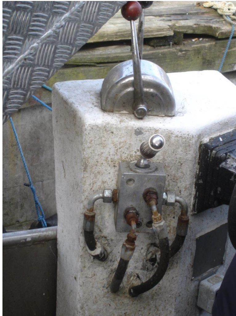
Figur 2: Manöverplats vid arbetsposition på däck. De övre spakarna reglerar framdrift, medan spaken mitt i bild reglerar garnvinschen. Till höger syns detalj av ratten.
