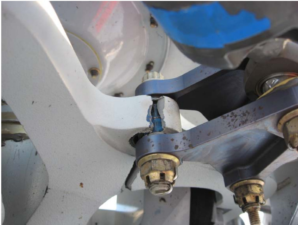
Fig. 7 Huvudrotornav med synlig spricka.
