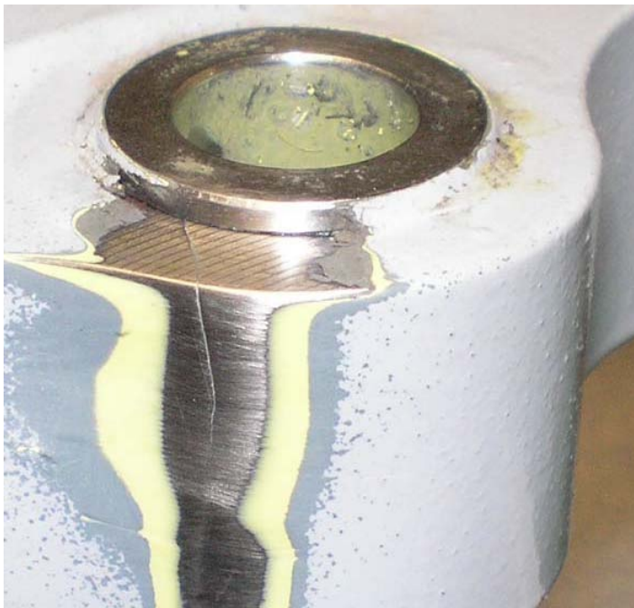
Fig. 10 Öra på skadat huvudrotornav med frilagd spricka individ S/N 1070.
