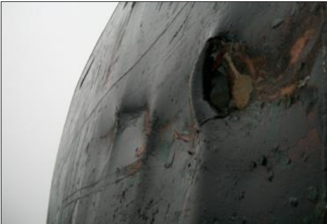
Bild 3: Hål i skrovet ovanför fartygets vattenlinje.
