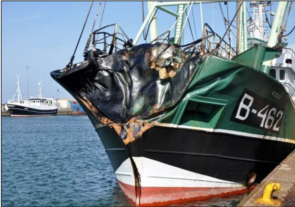
Bild 8: Skador på Vidars stäv sett från babord sida
