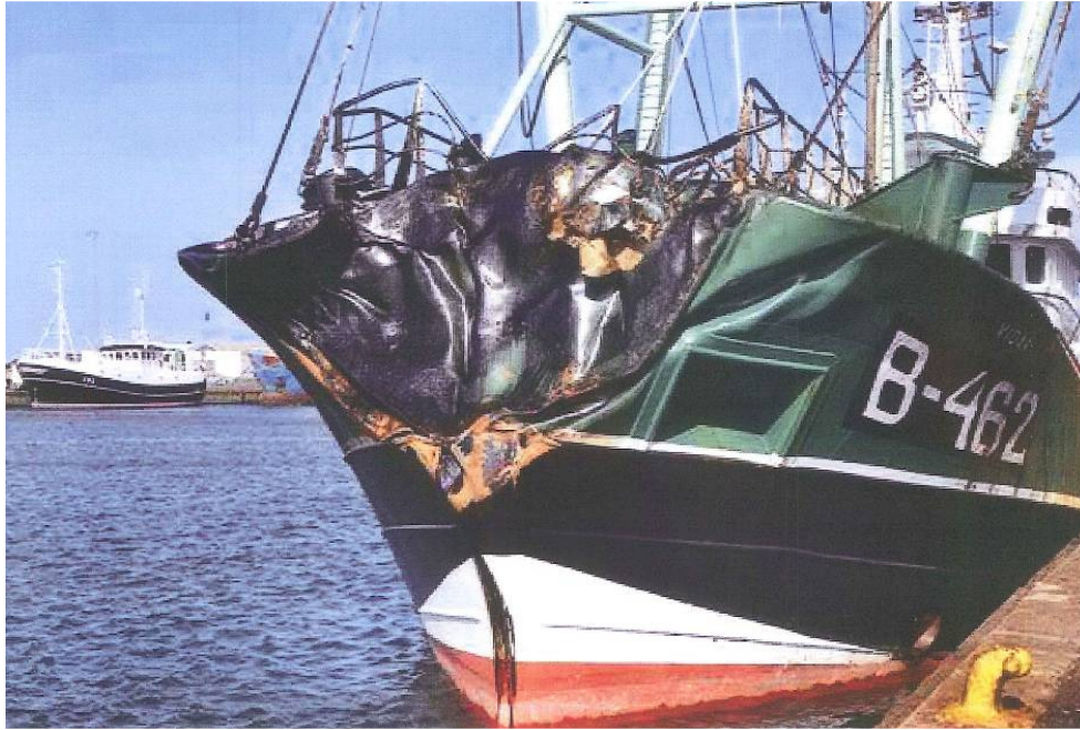
Figur 4 Fiskefartyget Vidar med intryckt för efter kollisionen (Foto: SOK)
