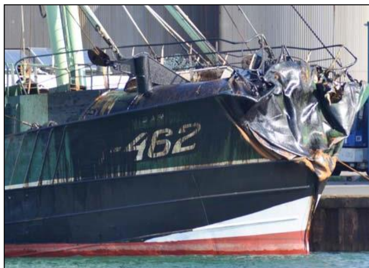
Bild 7: Skador på Vidars stäv sett från styrbord sida.
