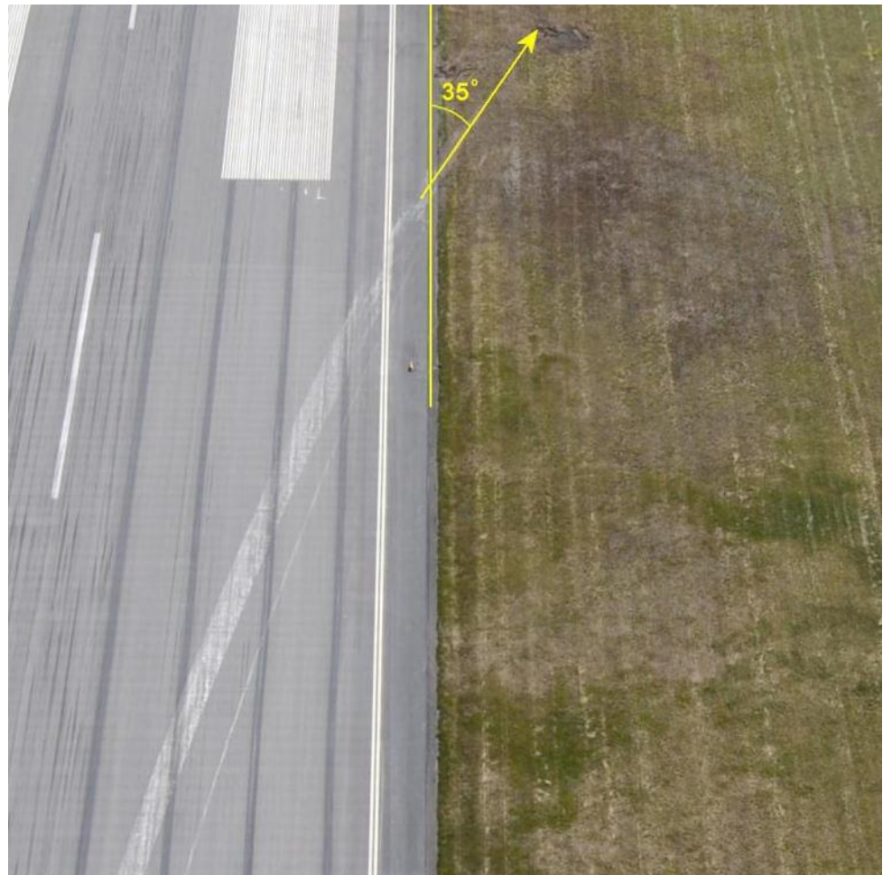
Fig. 6: Släpspåren på banan härrör från fälltanken och höger vingspets.
