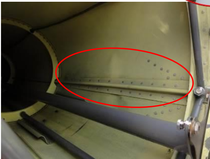
Fig. 2. Strukturskada i stjärtbommen. Foto: SHK.
