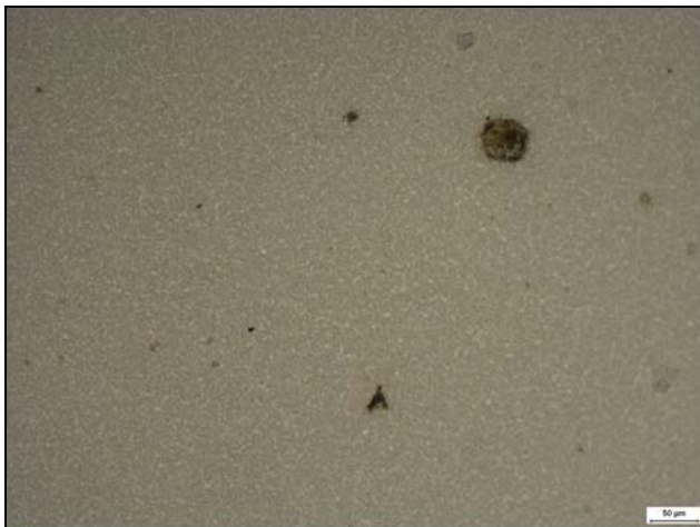
Figur 1. Föroreningar i bränsle i grön plastdunk.
