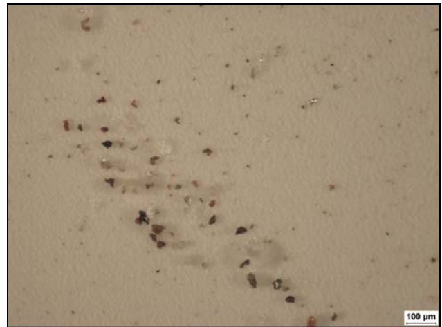
Figur 2. Föroreningar i bränslet från LN-OCX. Detta bränsleprov innehåller främst sandliknande partiklar. I övrigt återfinns även enstaka fibrer, men överlag är föroreningsnivån lägre i LN-OCX jämfört med LN-OGK och LN-OAB.
