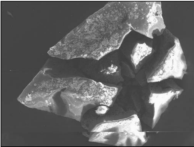
Figur 6. SEM-bild på brun förorening i prov märkt Förgasare LN-OAB 27/9-11. Föroreningen från figur 3 studerades även med ytelektronmikroskopi (SEM) där det konstateras att föroreningen är spröd, eventuellt i kristallin form. Under SEM kan man även undersöka partikeln med energidispersiv röntgenspektroskopi (EDS). Resultat med SEM-EDS återfinns i figur 7.
