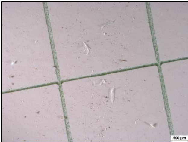
Figur 1. Föroreningar i bränsle från höger tank i LN-OAB.
