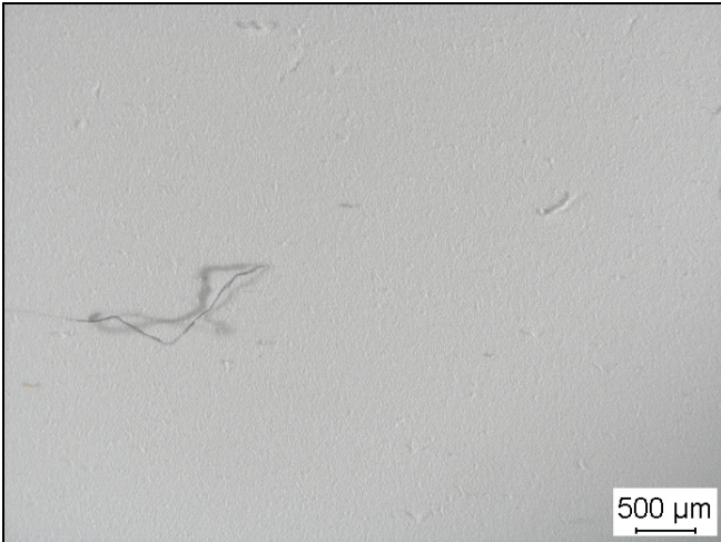
Figur 1. Föroreningar i prov märkt L/H fuel tank LN-OAB 12/9-11. Provet filtrerades genom ett membranfilter (Millipore AAWP, 0,8 µm porstorlek) varefter föroreningar som samlats upp på filtret studerades i mikroskop. I detta prov förekommer främst fibrer av varierande storlek. Karaktären hos fibrerna varierar, dock förekommer textilliknande och cellulosaliknande fibrer.
