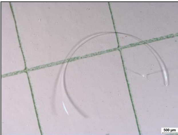
Figur 4. Föroreningar i bränsle efter att bränslet med tillsatta fibrer filtrerades genom bränslefiltret från LN-OAB.
