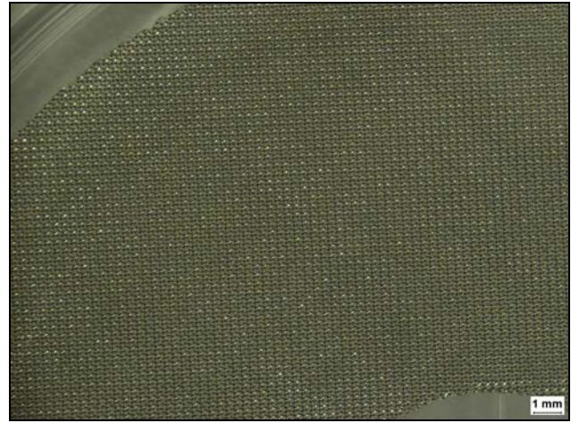
Figur 3. Föroreningar i bränslefilter efter det att bränslet filtrerats genom bränslefiltret från LN-OAB.
