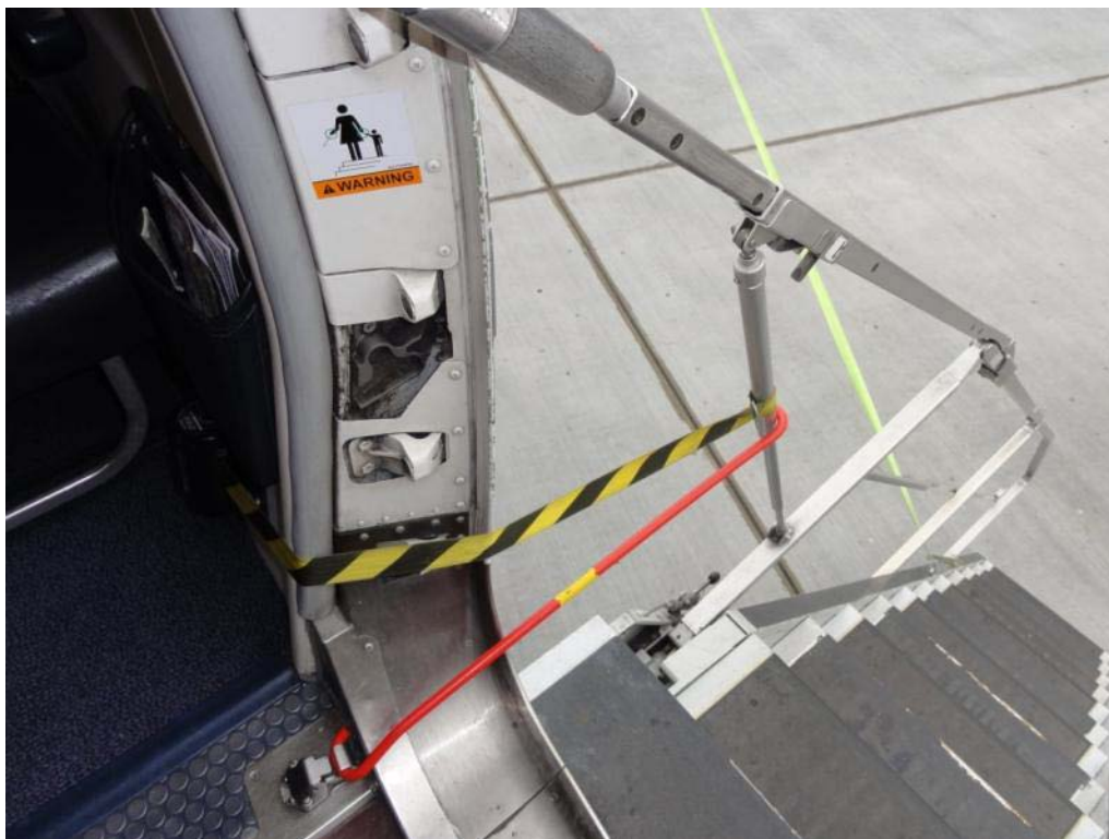
Fig. 3 – Övre del av flygplanstrappa med monterade fallskydd. Notera även varningsskylt.
