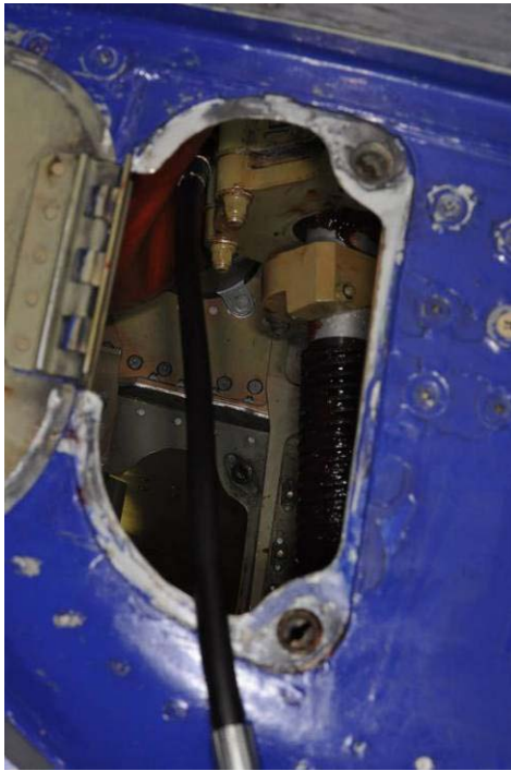
Fig. 8, Smörjning av stabilisatoromkraft (Jack Screw Support Assembly) via panel 3701A
