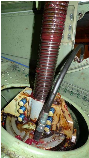
Fig. 7 Smörjning av stabilisatorns balansring (Jack Screw Gimbal Ring) via panel 3701A
