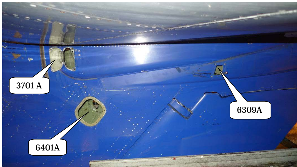
Fig. 6 Öppnade paneler på vänster sida för smörjning av stabilisatoromkraft (Jack Screw) och stabilisatorgångjärn enligt Boeing MD-80 AMM
