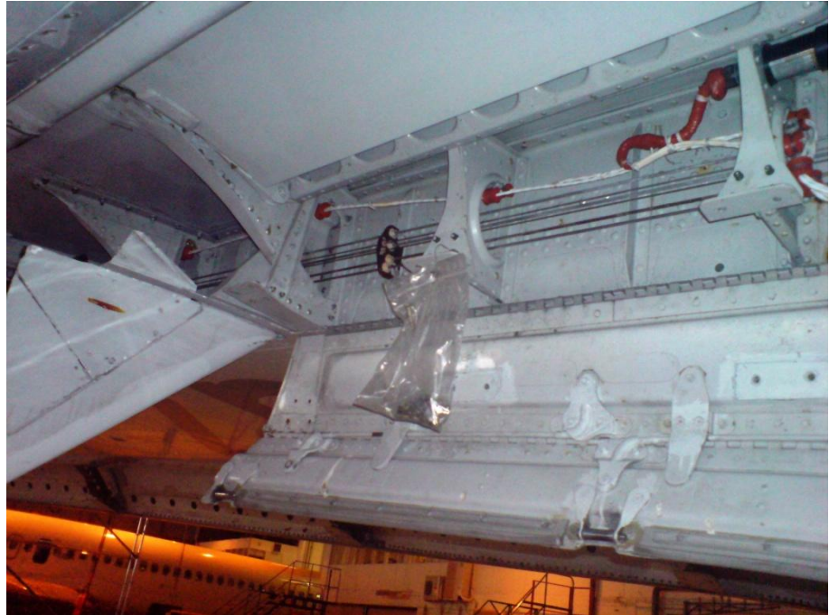
Photo 19: LH Bute door screws in bag, OY-KGZ.
