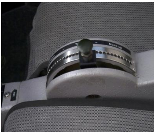
Fig. 3. Trimreglagetets position, vilket stod nära neutralt läge.
